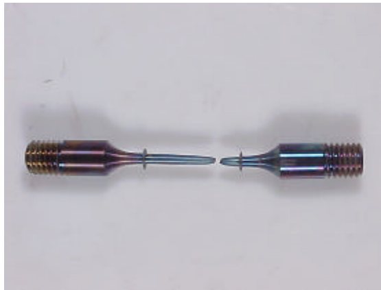
FIGURA 4.3 – Corpo de prova após ruptura em ensaio a 600°C e 250MPa.
