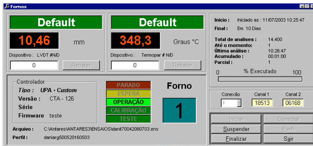
FIGURA 3.11 – Monitor de vídeo no momento da execução de um teste de fluência.
