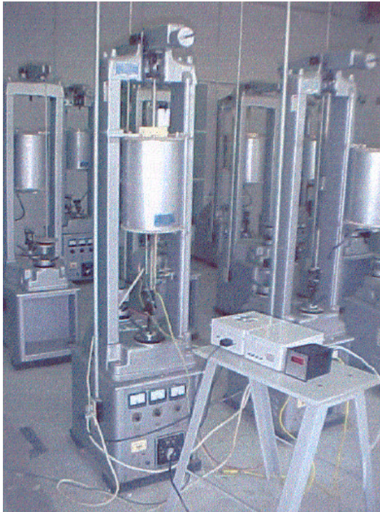
FIGURA 3.3 - Forno de fluência realizando um ensaio ao ar.
