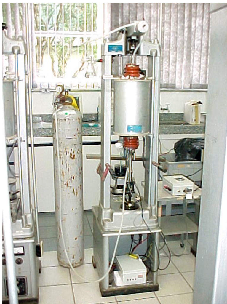
FIGURA 3.6 - Forno de fluência com fole de vedação para ensaio com atmosfera de nitrogênio.
