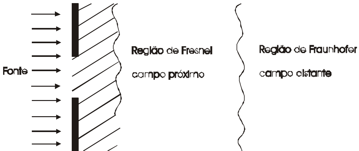
FIGURA 3.3 Diagrama mostrando as posições relativas da região de Fresnel (campo próximo e região e Fraunhofer (campo distante).
