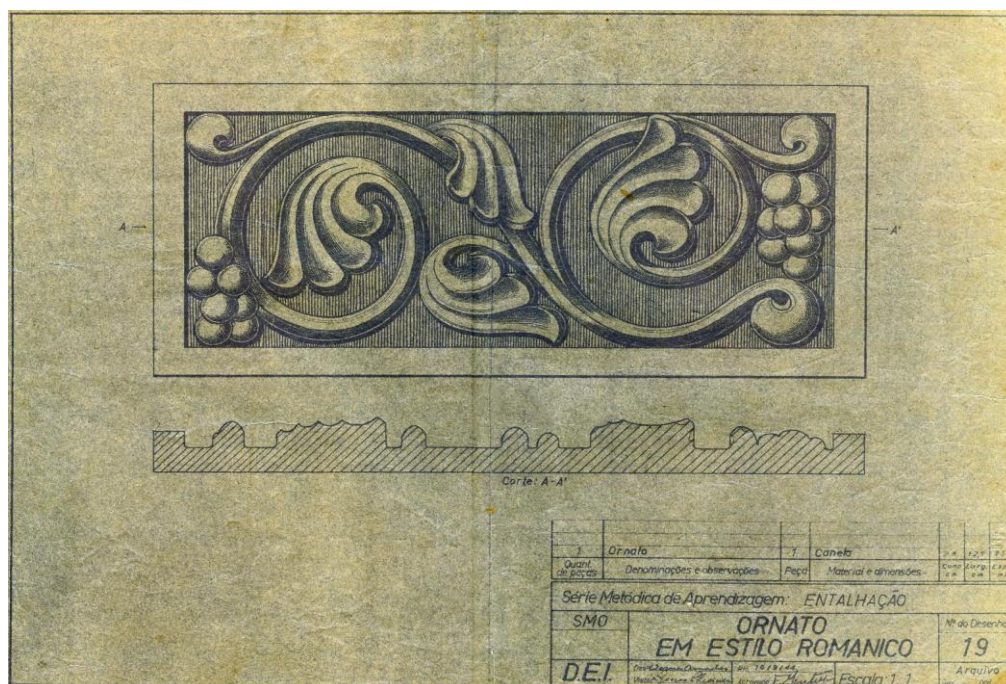
37. Desenho da Série Metódica de Aprendizagem para a Seção de Entalhação. Ornato em estilo românico, com relevos de folhas e frutas. Discriminadas as especificações de corte e escala 1:1, 40x30cm, 1944.
