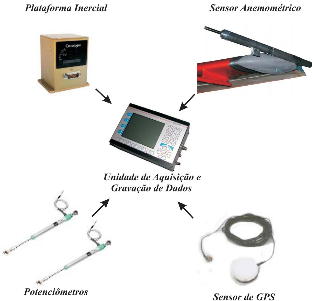
Figura 4.51: Componentes principais do sistema de aquisição de dados
