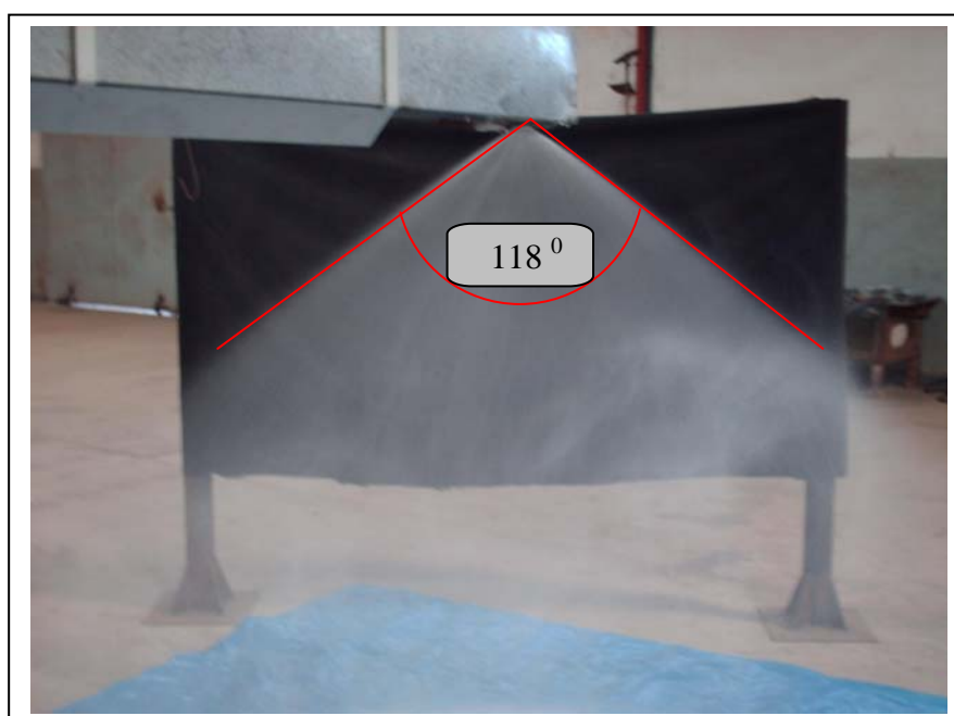
Figura 3.4.14 - Angulo de 118 graus do cone externo
