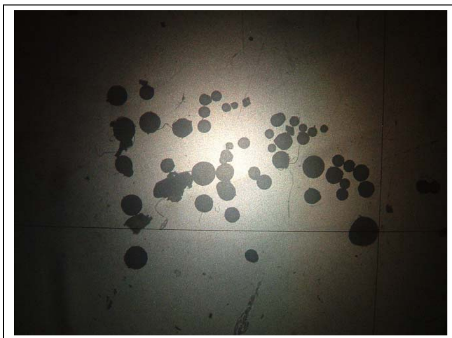
Figura - 3.1.3 gotas de parafina solidificada medindo de 0,012 a 0,951 mm
