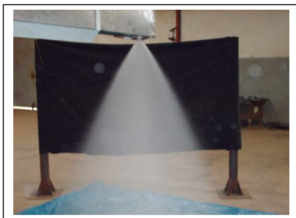
Figura 3.4.15 - Cone Líquido oco do injetor interno a 5 atm.
