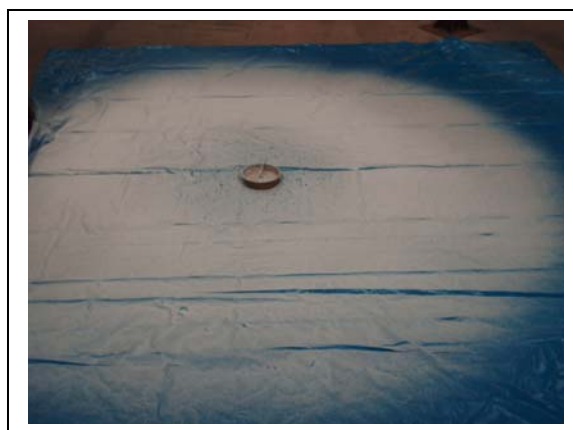
Figura 3.4.13 - Gotas do injetor externo no anteparo a 5 atm.
