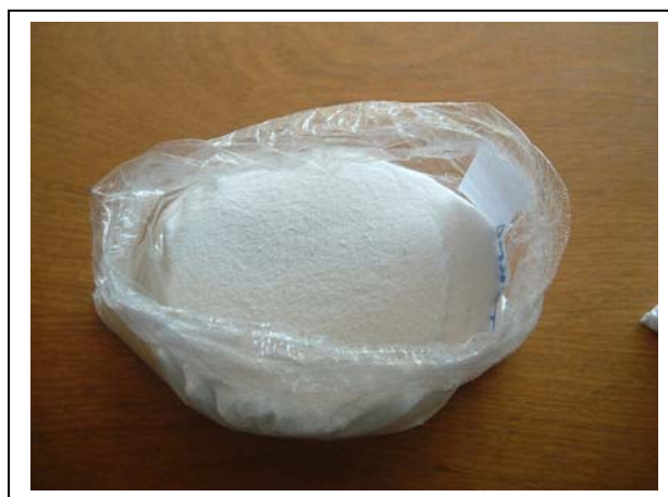
Figura 3.4.9 - 1,20 kg. de gotas de parafina do injetor externo
