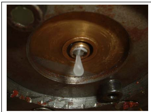
Figura 3.4.11 - Gota de parafina solidificada na saída dos injetores.
