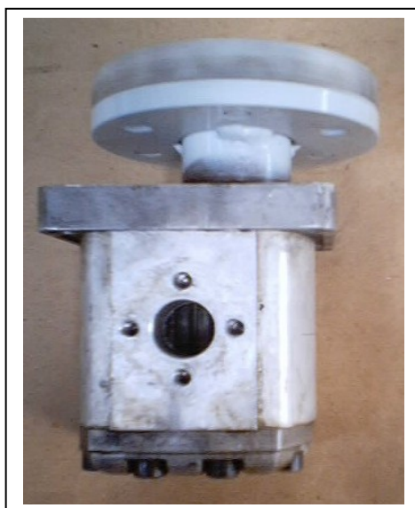
Figura 3.3.1 - Bomba hidráulica de engrenagens com acoplamento
