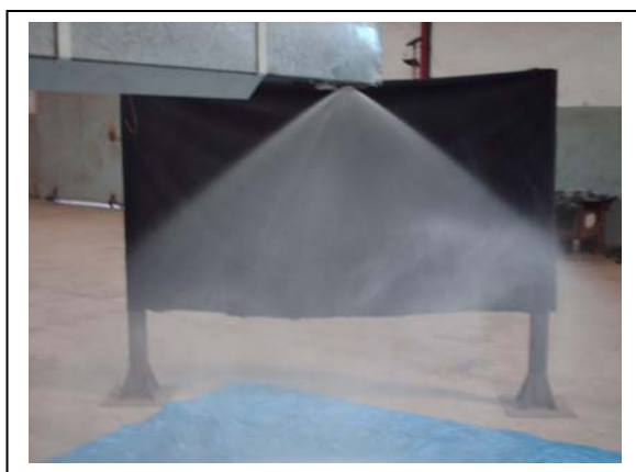
Figura 3.4.12 - Cone Líquido oco do injetor externo a 5 atm
