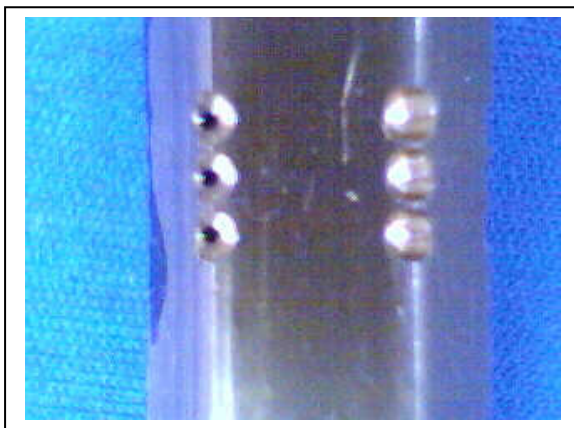
Figura 3.2.4 - Seqüência de furos e de centros
