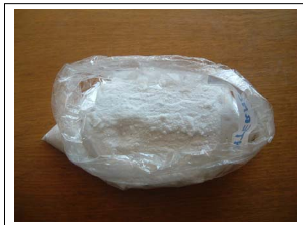
Figura 3.4.10 - 0,65 kg. de gotas de parafina do injetor interno
