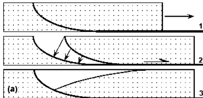
Figura 2.9 – Mecanismo de formação do Rollover (Schlishe, 1995)
