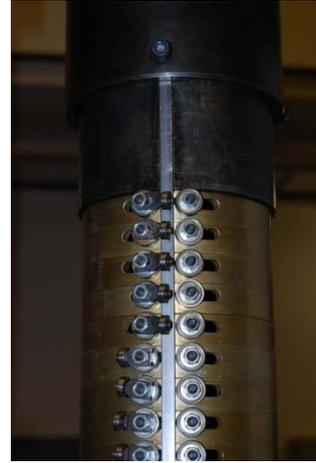
Figura 28 – Exemplo de confinamento da barra reta (condição de contorno)
