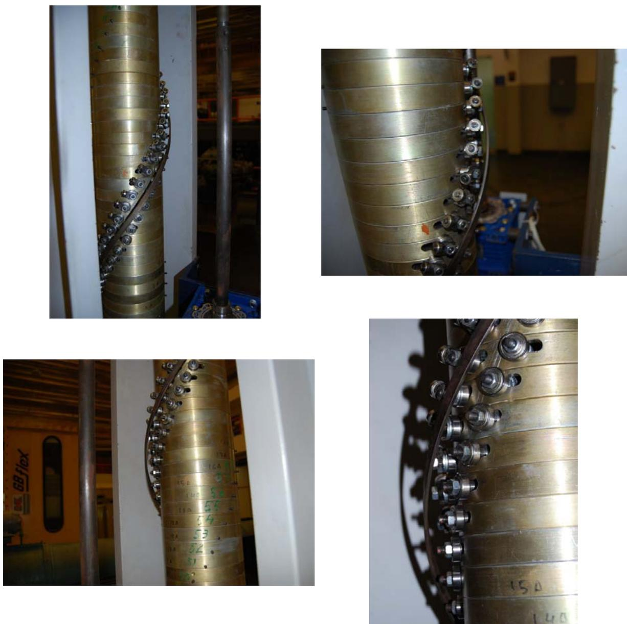
Figura 46 – Exemplo de comportamento de barra curva livre no sentido radial.
