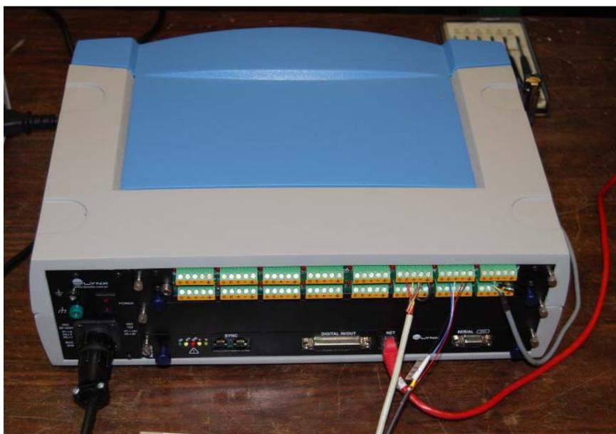
Figura 30 – Equipamento de aquisição de dados LYNX ADS 2000
