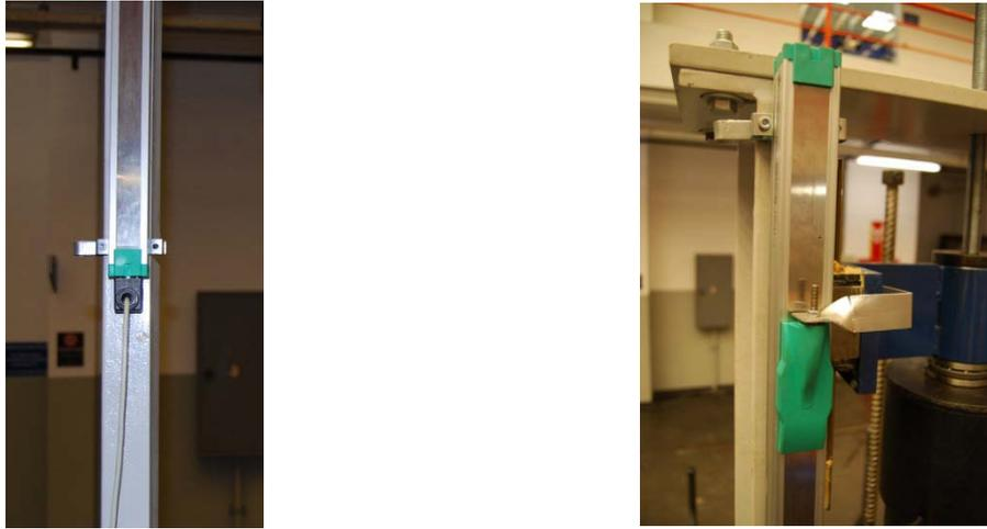
Figura 22 – Detalhe dos suportes para LVDT
