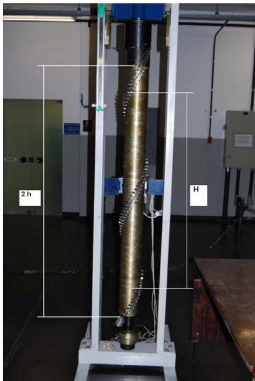
Figura 68 – Vista do aparato para ensaios com barras de altura total próximas a dois passos.
