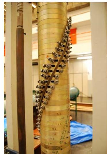
Figura 61 – Vista do dispositivo modificado para ensaios em barras com  $L_e$  correspondente a um passo.
