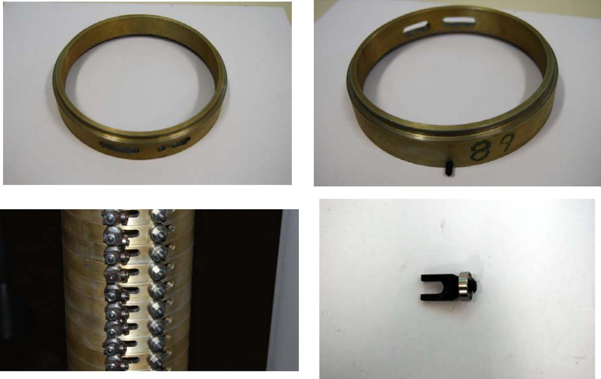
Figura 20 – Detalhe dos anéis, parafusos e rolamentos
