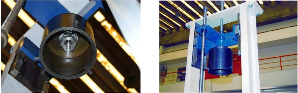
Figura 23 – Detalhamento do cabeçote, guias, copo acionador e fuso de esferas.
