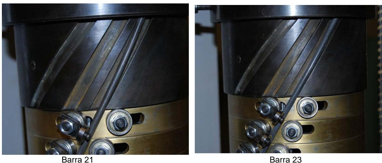
Figura 48 – Exemplos de alojamento da barra no rasgo do anel.
