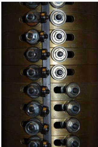
Figura 32 – Condição de contorno e ajuste dos rolamentos para ensaios de instabilidade com liberdade no sentido lateral
