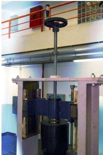
Figura 26 – Manivela de aproximação e travamento do conjunto de anéis
