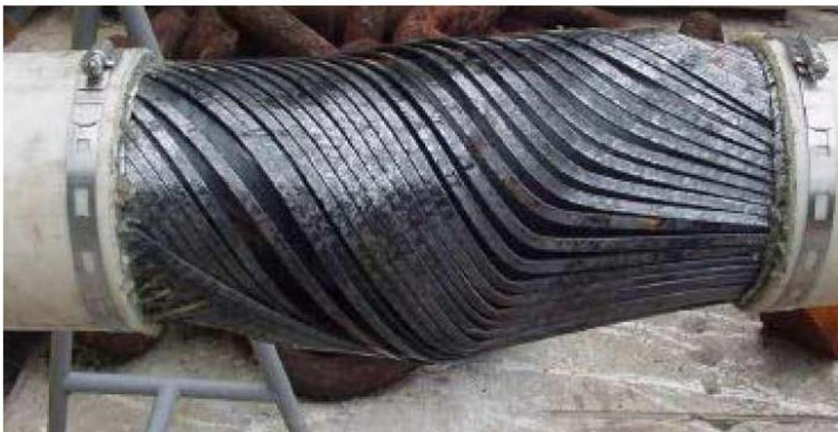
Figura 5 – Tubo flexível após falha por instabilidade [11]
