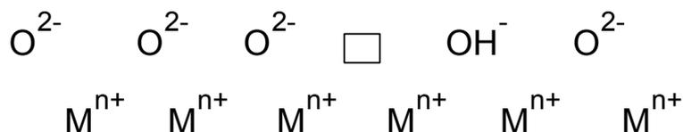
Figura 13. Superfície de um catalisador iônico<sup>28</sup>, evidenciando um sítio vacante.
