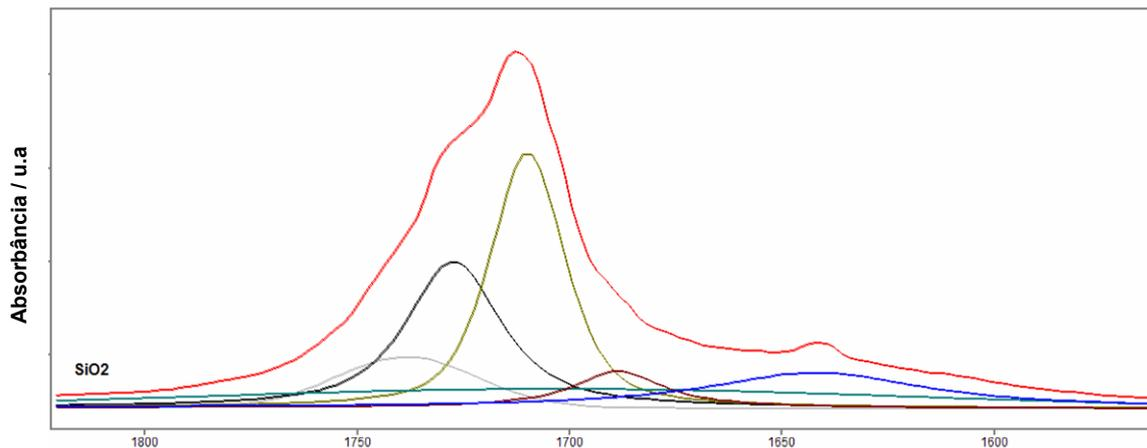
Figura 23. Deconvolução da curva do espectro da amostra de craqueamento na presença de SiO<sub>2</sub>.
