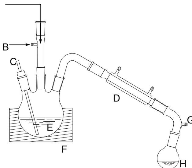
Figura 12. Outro exemplo de reator em batelada para craqueamento. Injetor do óleo (A); Entrada do gás de arraste (B); termopar (C); condensador (D); balão reator (E); Manta de aquecimento (F); Saída de gás (G); Balão coletor do produto líquido (H).
