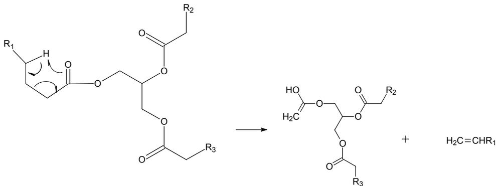
Figura 6. Proposta mecanística da transferência do hidrogênio gama em craqueamento.
