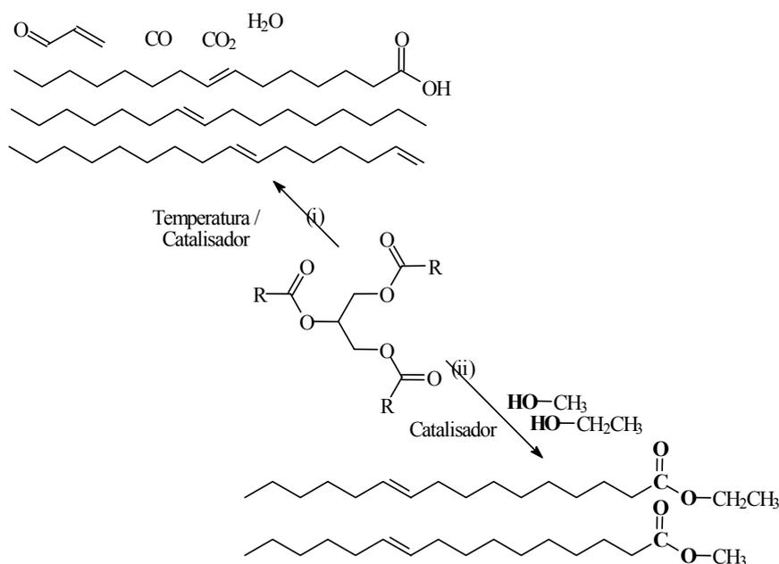
Figura 1. Reação de craqueamento (i) e transesterificação (ii), mostrando que os processos e os produtos dos dois são diferentes.
