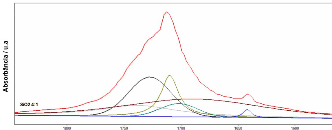
Figura 24. Deconvolução da curva do espectro da amostra de craqueamento na presença de SiO<sub>2</sub>/TiO<sub>2</sub> (4:1).
