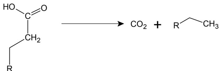
Figura 8. Representação esquemática do processo de descarboxilação.
