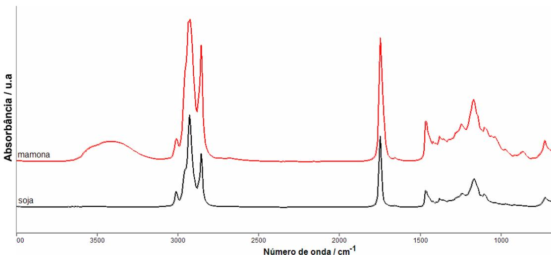
Figura 16. Comparação entre os espectros obtidos do óleo de mamona e soja, mostrando uma das evidências da presença do grupo hidroxila na mamona pela absorvância de 3700 a 3200 cm<sup>-1</sup>.
