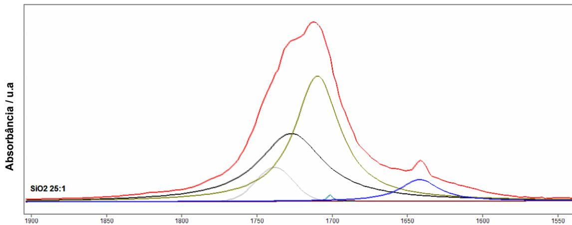
Figura 22. Deconvolução da curva do espectro da amostra de craqueamento na presença de SiO<sub>2</sub>/TiO<sub>2</sub> (25:1).
