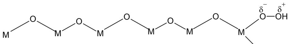
Figura 14. Superfície de um catalisador covalente, por exemplo SiO<sub>2</sub>, evidenciando sua acidez pela presença de hidrogênio ácido.
