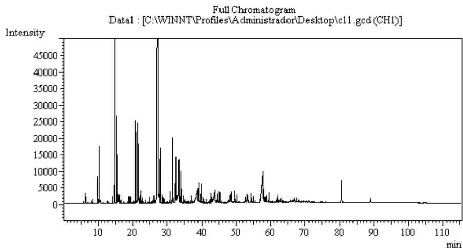
Craqueamento catalítico com  $\text{TiO}_2/\text{SiO}_2$  (razão 1:3)
