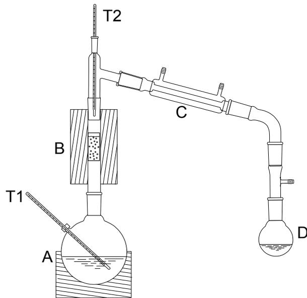
Figura 10. Reator para craqueamento em batelada com catalisador em leito fixo. A reação ocorre no balão aquecido (A) e os gases formados atravessam o leito com catalisador (B) para depois serem condensados (C) e ser coletada a fração líquida (D). As temperaturas do óleo e do vapor também são monitoradas (T1 e T2).
