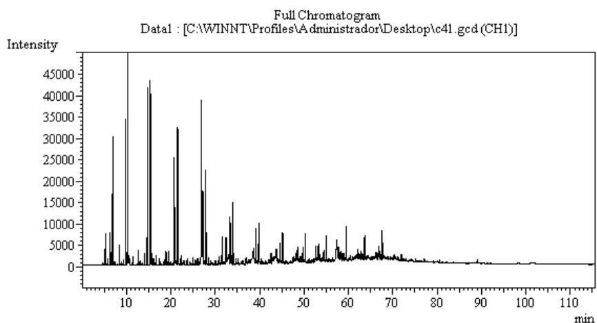
Craqueamento catalítico com  $\text{SnO}/\text{Al}_2\text{O}_3$
