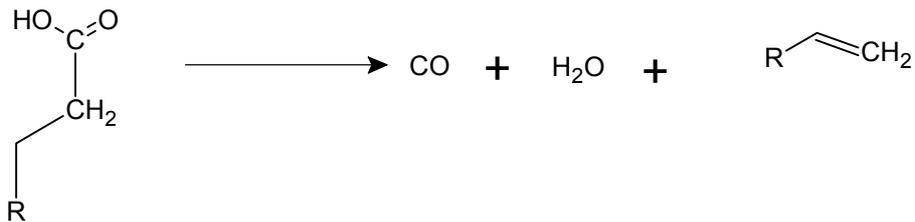
Figura 7. Representação esquemática do processo de descarbonilação.
