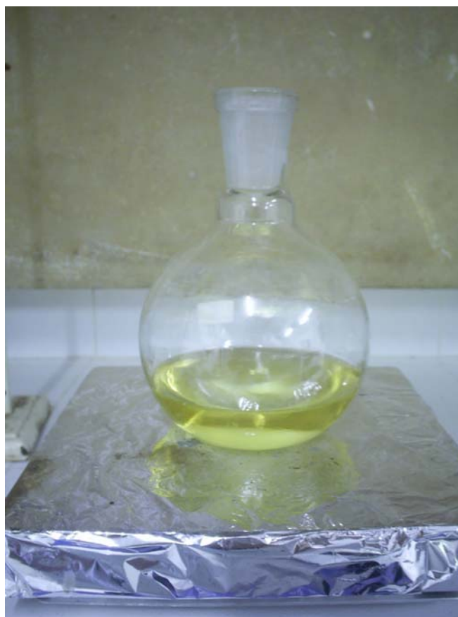
Figura 4.1: Processo de agitação do metóxido de sódio com o óleo de mamona
