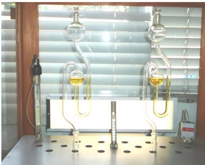
**FIGURA 13** - Montagem para análise dos propelentes na prova Bergman & Junk.
