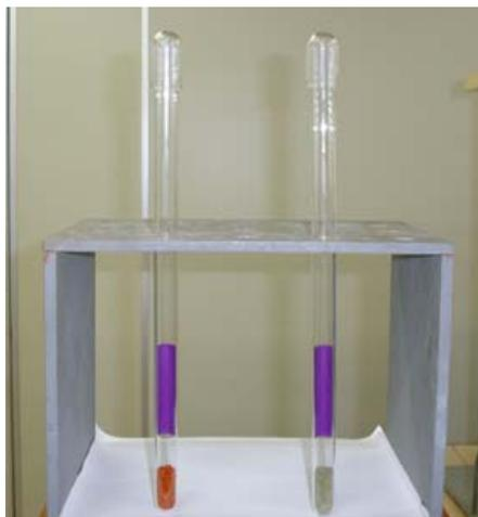
**FIGURA 14** - Amostras dos propelentes para prova Alemã de estabilidade.
