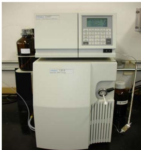
**FIGURA 11** – Aparelho de cromatografia líquida de alta eficiência da Waters Associates.
