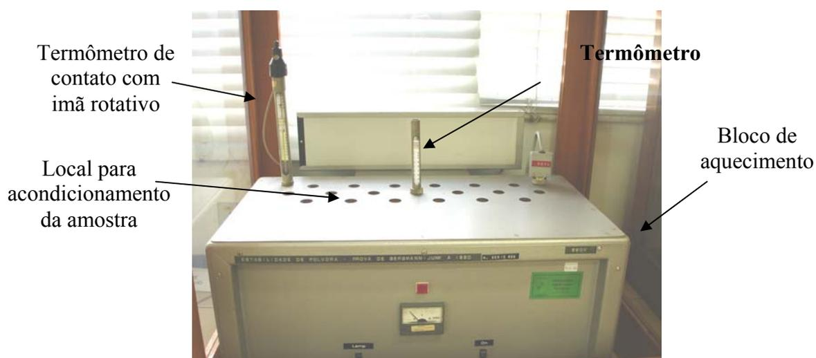
**FIGURA 8** - Bloco de aquecimento com controle automático de temperatura.
