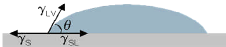
Figura 15 – Definição do ângulo de contato \theta entre uma gota líquida e uma superfície plana e horizontal [46].
