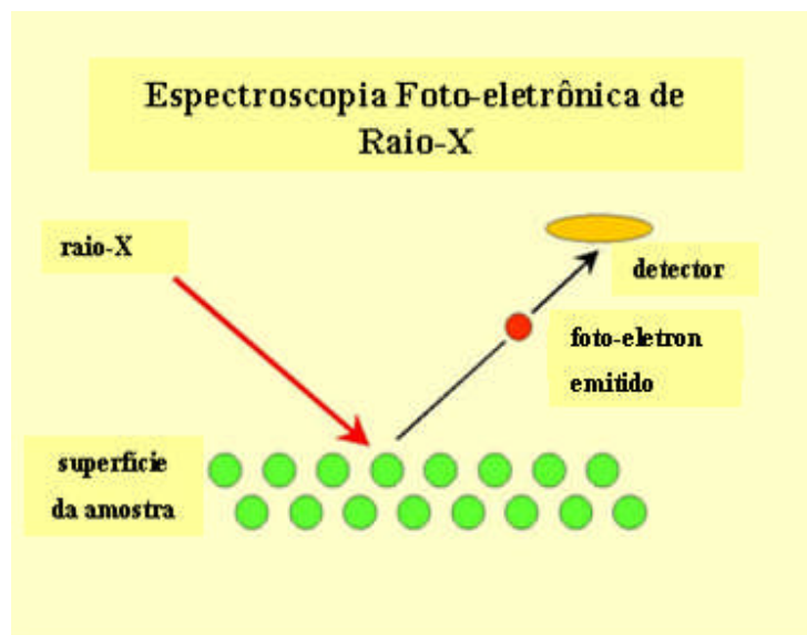
Figura 18 – Modelo da geração de um espectro foto-eletrônico [57].
