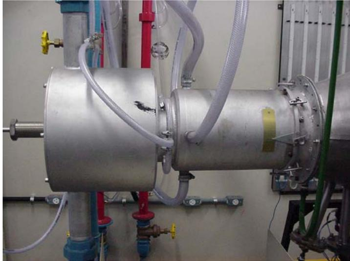
Figura III.9 – Fotografia do Distribuidor de Ar.
