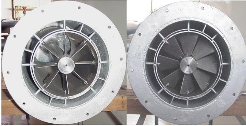
Figura III.11– Dispositivo Gerador Vortical/axial com pás de ângulo variáveis (Figura da esquerda "swirler " aberto 0° e da direita "swirler " fechado 70° graus).
