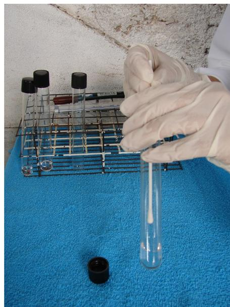
**Figura 4.** Swab sendo emerso rapidamente em diclorometano 99% HPLC em tubo de vidro vedado.
