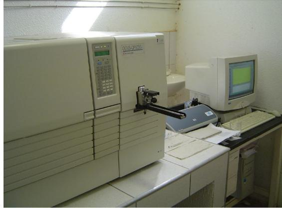
**Figura 6.** Instrumento Hewlett-Packard 5971 para análise cromatográfica e espectrofotométrica.
