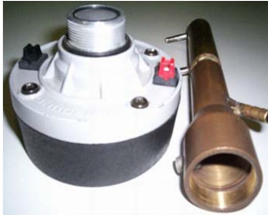
Figura 3.4 Imagem do queimador e alto-falante desacoplados.
