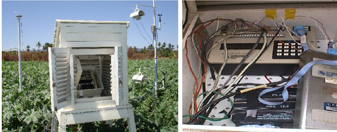
Figura 3.3. Detalhe da torre micrometeorológica com o sistema de aquisição de dados (E) e do módulo de armazenamento (D). Barbalha, CE, 2005.
