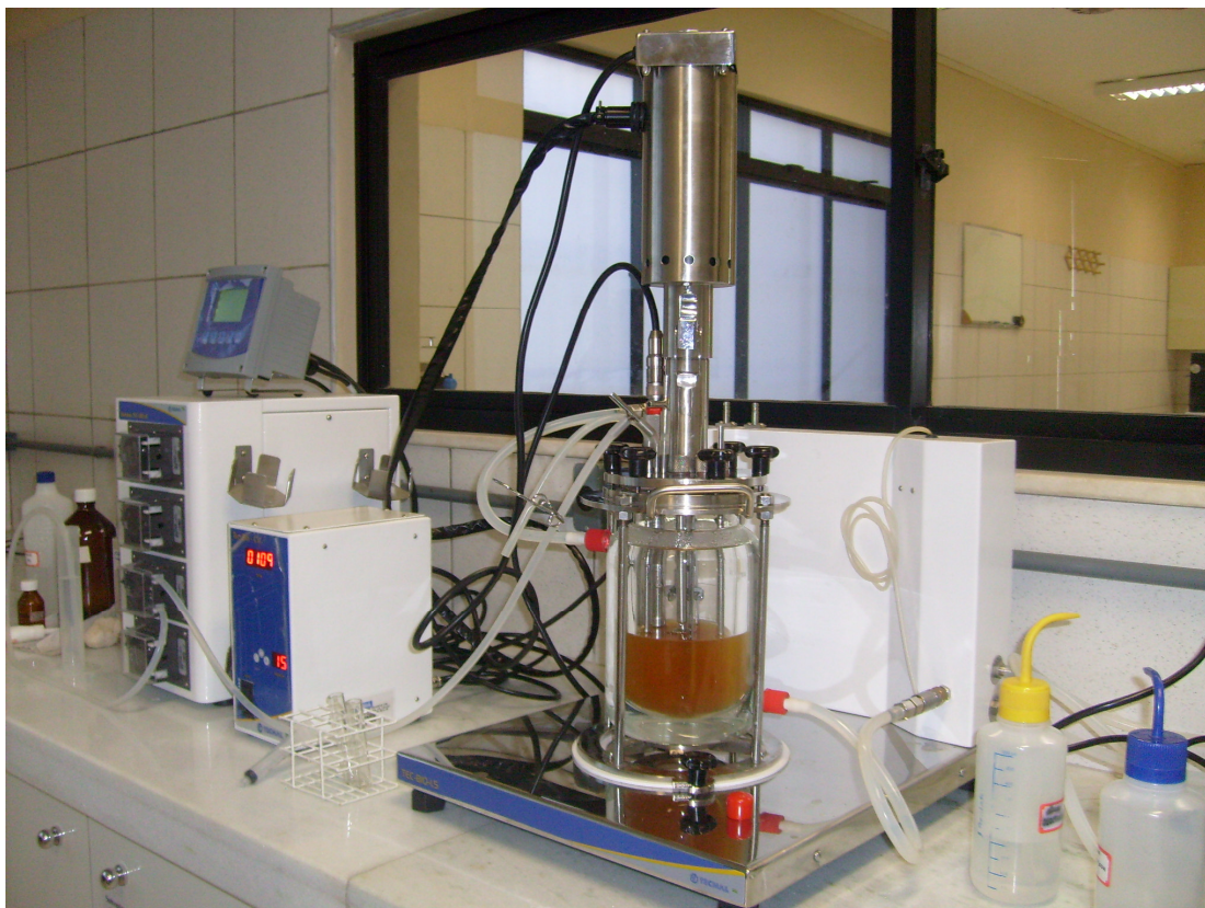
Figura 3 - Fermentador TECNAL, modelo TE-420 de 1,0 L.
