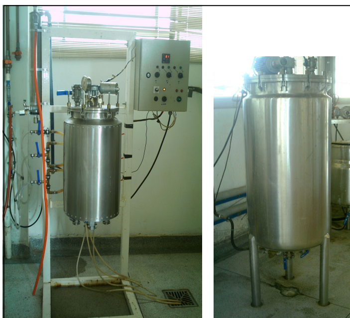
FIGURA 9. Reatores agitados, construídos com aço inox tendo volume de 15 e 80 litros respectivamente.
