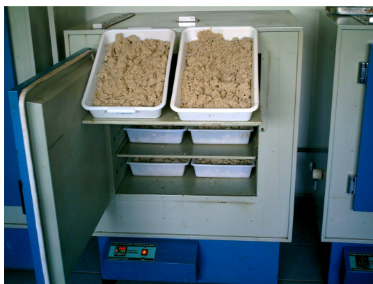
FIGURA 10. Amostras dos resíduos de raízes de mandioca filtrados e dispostos em bandejas para secagem.
