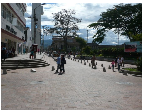
Figura 35 – Carrera 4 (2008). a praça está ao mesmo nível da rua, o que permite o fácil acesso para as pessoas com mobilidade física reduzida.
