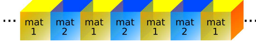
Figura 4.2: Super-rede - a heteroestrutura é repetida indefinidamente ao longo da direção de crescimento
