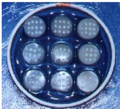
**Figura 9 - Pastilhas após a irradiação sendo preparadas para avaliação sob MEV.**
