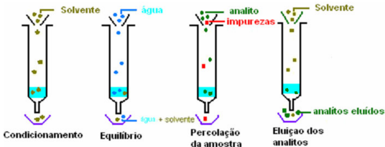
Figura 4: Etapas em SPE para isolamento de um composto.
