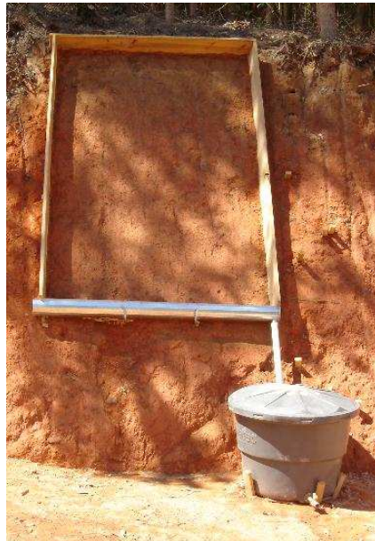
FIGURA 8- Instrumentação de Campo (exemplo de uma célula completa).
