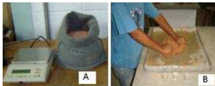
FIGURA 20 – Processo de medição indireta do peso dos sedimentos sólidos, (A) bolsas de geotêxtil com os sedimentos mais grossos coletados em campos (B) homogeneização da umidade da amostra.
