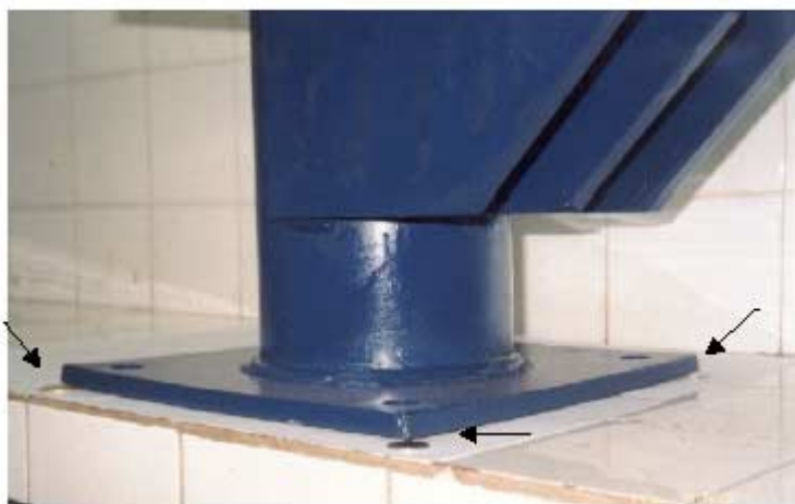
Figura 3.4 – Foto das imperfeições nos Protótipos 1 e 2.
