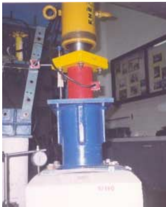
Figura 4.16 – Foto da região da placa de base onde houve deformação aparente no Ensaio 3.
