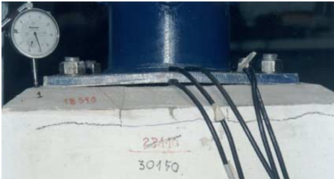
Figura 4.10 – Foto da região da placa de base onde houve deformação aparente no Ensaio 2.
