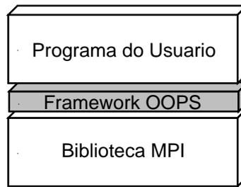
Figura 4.6: Esquema em camadas de um programa utilizando o *framework* OOPS. O OOPS representa uma camada fina entre o programa do usuário e a biblioteca MPI de forma a não representar uma grande sobrecarga para a aplicação e não comprometer seu desempenho.
