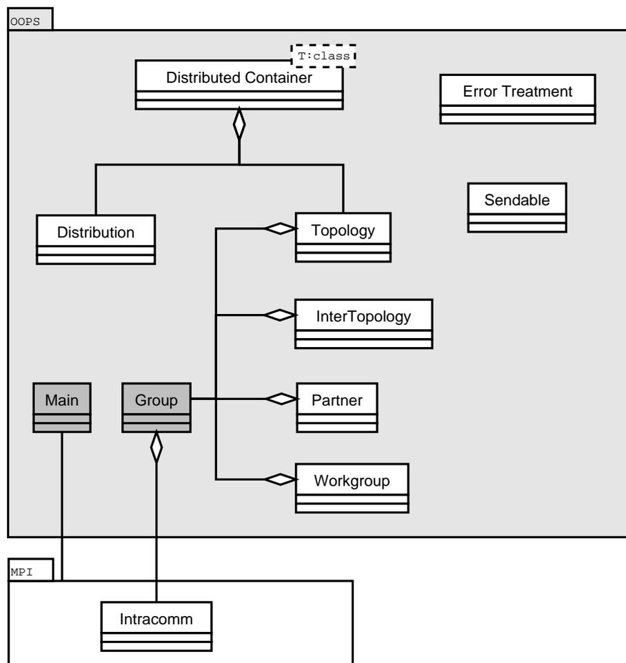
Figura 4.14: Diagrama da interoperabilidade das classes do OOPS.
