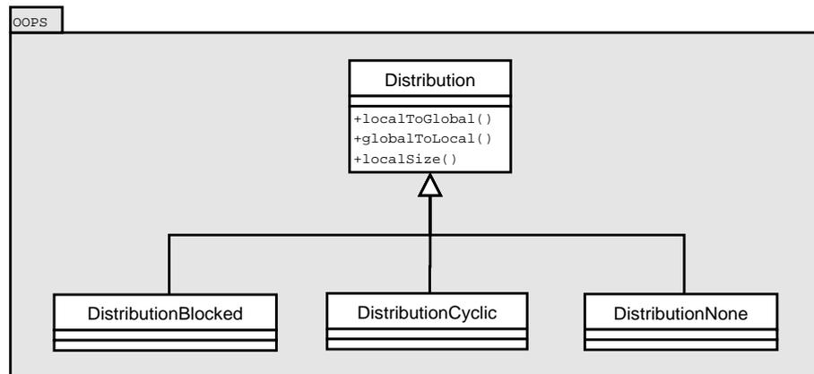
Figura 4.10: Diagrama da herança de classes que modelam modos de distribuição dos contêineres. As setas na figura partem da classe derivada para a classe base.
