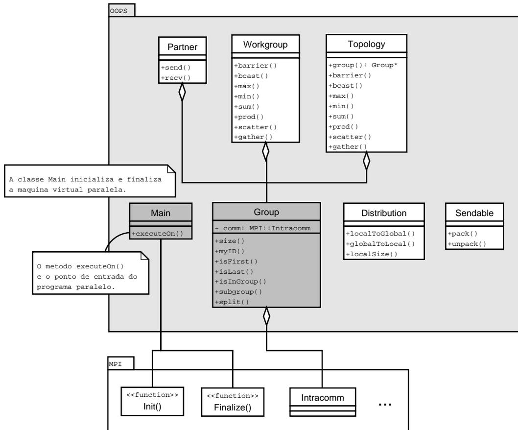
Figura 4.7: Diagrama das classes básicas do OOPS. Somente as classes `OOPS::Main` e `OOPS::Group` se relacionam diretamente com MPI. As ligações mostram que a topologia, o parceiro e o grupo de trabalho são construídos sobre um grupo de processadores virtuais.
