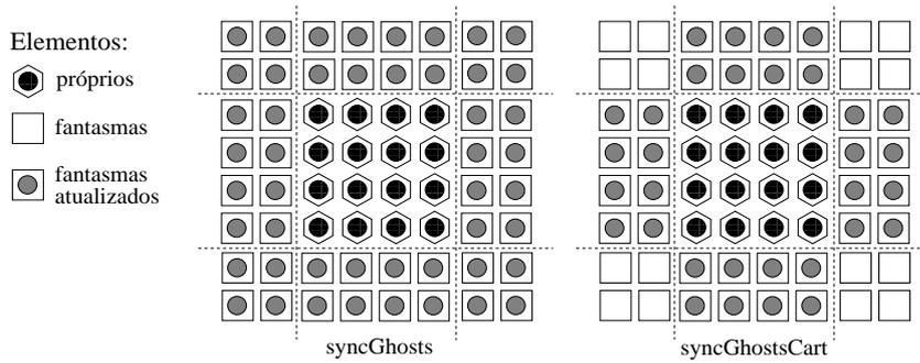
Figura 4.12: Ilustração das atualizações dos elementos fantasmas em uma matriz distribuída utilizando os métodos `OOPS::Matrix<T>::syncGhosts()` e `OOPS::Matrix<T>::syncGhostsCart()`.
