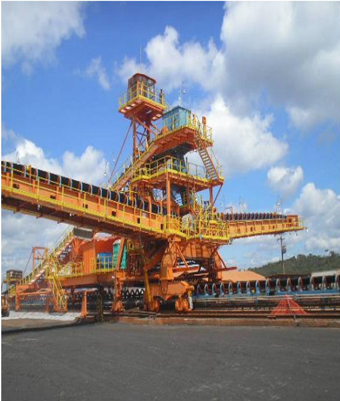
Figura 12: Sistema de desvio e empilhagem de material
