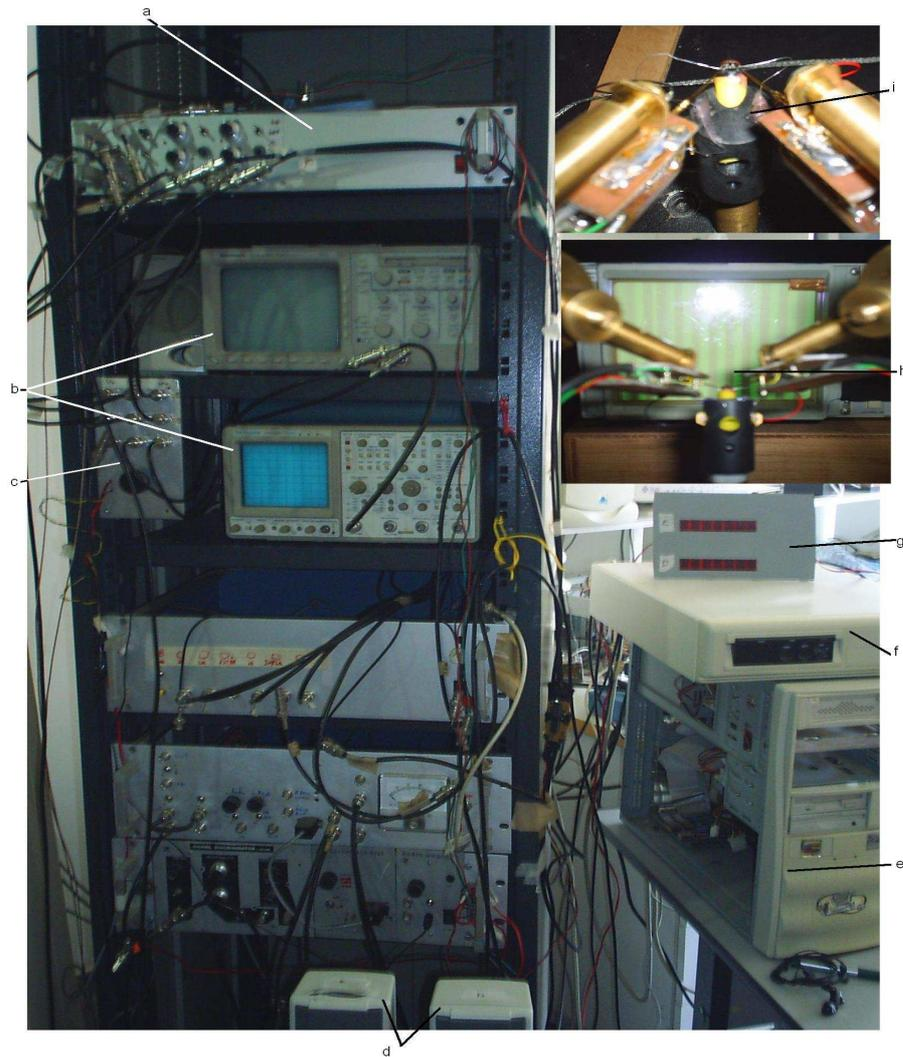
Figura 8: O equipamento (a - discriminador; b - osciloscópios; c - placa chaveadora; d - caixas de som; e - PC com RTLinux; f - hardware dedicado; g - contador de spikes; h - monitor; i - a mosca preparada para a aquisição)
