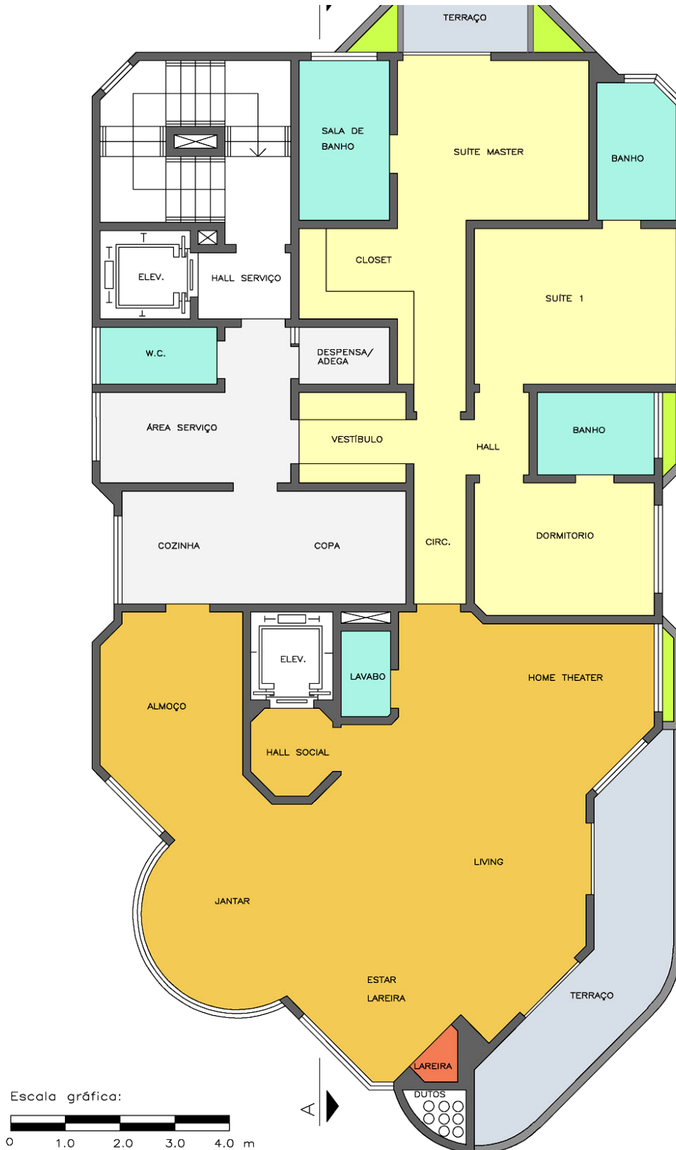
Figura 9 – Planta digitalizada do andar tipo, apresentando uma das possíveis resoluções, em virtude de apenas dois pontos estruturais de apoio em seu interior: (2) dutos de elevadores: social e serviço (2006)
