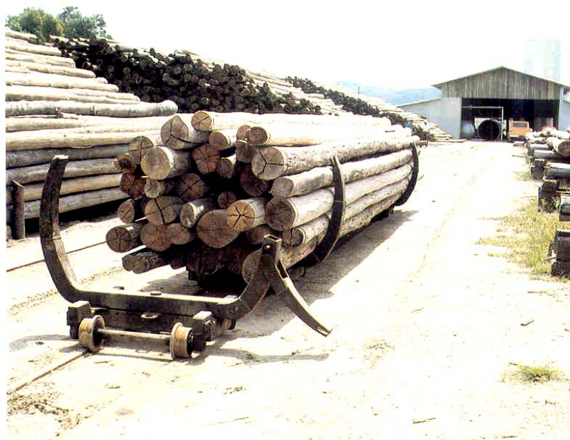
Figura 2.15 – Postes transportados em vagonetes para a autoclave onde serão impregnados com preservativos de madeira para aumentar sua durabilidade. Fonte: FUNDAP (s.d.)
