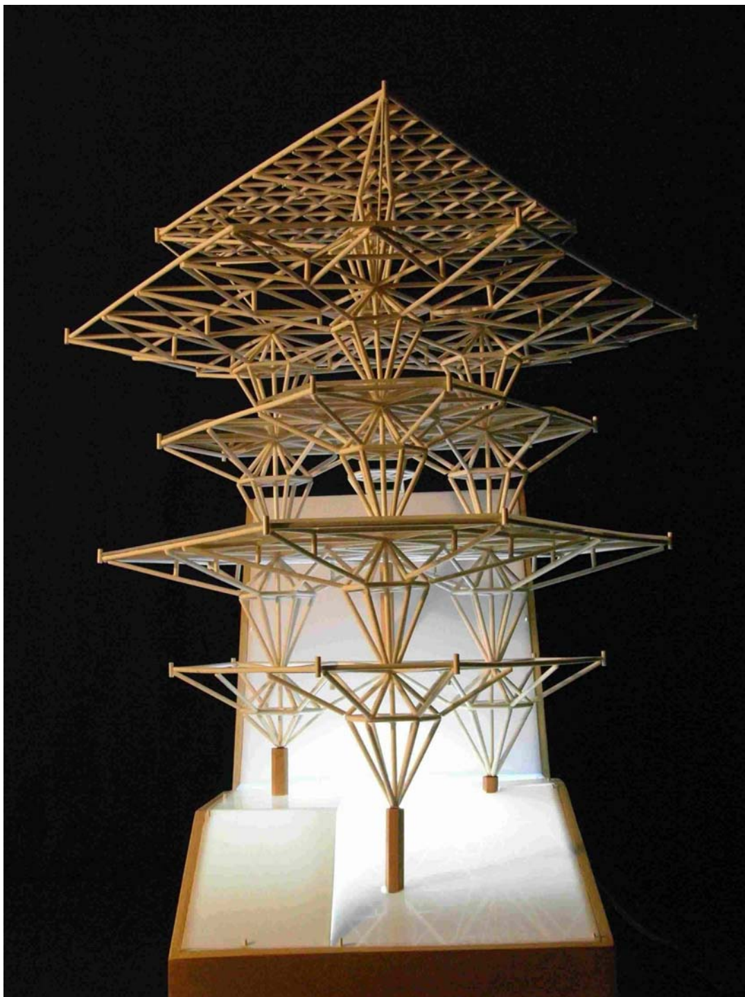
Figura 3.76 -Trelçado espacial - maquete na escala 1:50 --quatro pavimentos mais a cobertura – primeira versão Execução do próprio autor (2005) - Fonte: FAUUSP. Foto de Cândida Maria Vuolo (Março de 2005)
