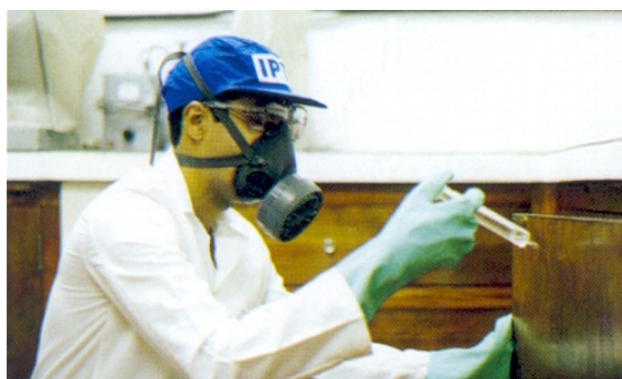
Figura 2.45 – Tratamento com solução inseticida, utilizando seringa hipodérmica. Fonte: IPT (2001)
