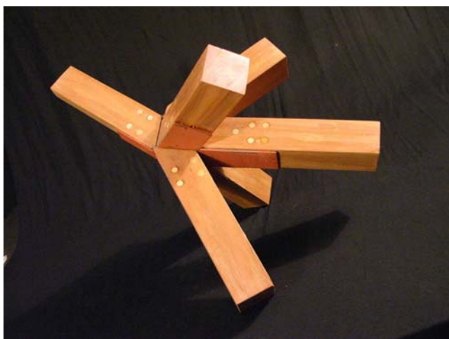
Figura 3.84 – Protótipo da ligação metálica – hexágono do “diamante” – vista da parte inferior Fonte: FAUUSP. Foto de Roberto Bogo (Março de 2005)
