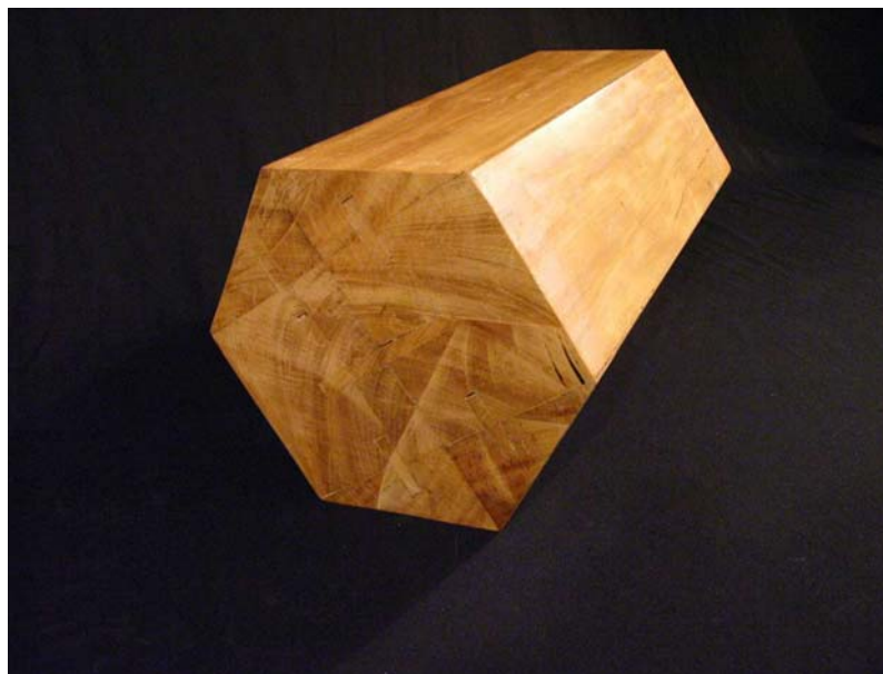
Figura 3.83b – Protótipo da coluna de madeira na escala 1:1 – execução do próprio autor Fonte: FAUUSP. Foto de Roberto Bogo (Março de 2005)
