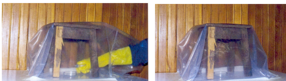
Figura 2.44 – Expurgo ou fumigação com gás tóxico em peça de madeira. Fonte: IPT (2001)
