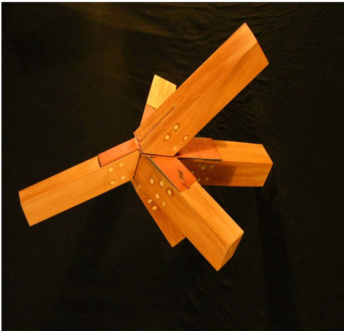
Figura 3.78 – Protótipo de ligação metálica na escala 1:1 – nó articulado do hexágono do “diamante” – vista inferior. Fonte: FAUUSP. Foto de Roberto Bogo (Março de 2005)
