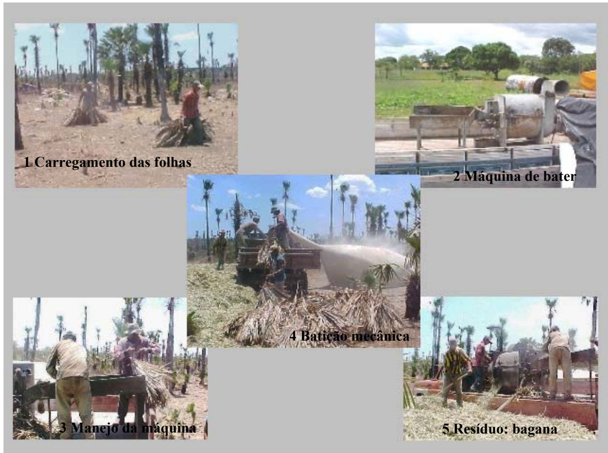
Figura 8 – Etapas finais do processo de produção de pó cerífero de carnaúba - batição mecânica das folhas.
