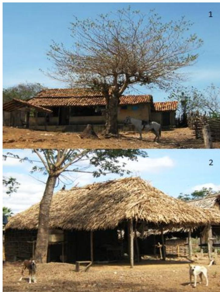
Figura 07: Fotos representativas de estruturas físicas das casas situadas no entorno da Lagoa do Cajueiro: 1- Taipa com cobertura de telha. 2- Toda em palha.
