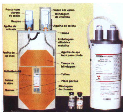
Figura 2. Gerador de molibdênio-99/tecnécio-99m Fonte: IPEN/CNEN-SP
