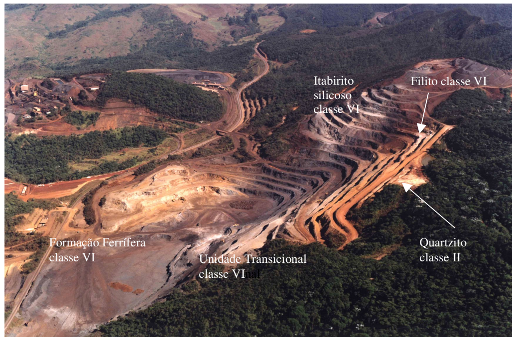
Figura 4.6 – Classificação geomecânica dos maciços da Mina de Gongo Soco
