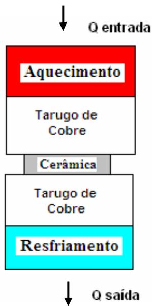
FIGURA 3.8 - Desenho esquemático do posicionamento da amostra cerâmica porosa no condutímetro.
