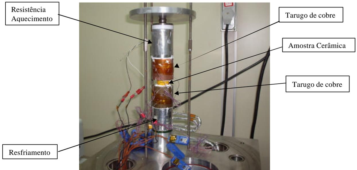
FIGURA 3.9 - Condutímetro instalado na DMC/ETE, teste de condutividade térmica.
