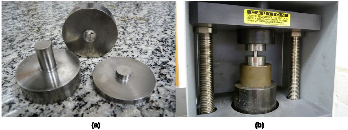
FIG. 3. 1 (a) Matriz metálica usada para fazer as pastilhas; (b) Prensa hidráulica.
