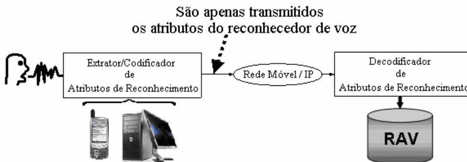
Figura 2.4 – Sistema de reconhecimento de voz distribuído com codificação dos atributos de reconhecimento no front-end local
