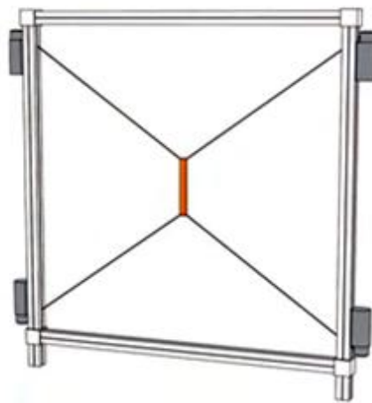
FIG. 2.6 - 1R2T: Movimento de um corpo no plano
