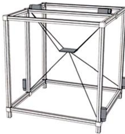
FIG. 2.9 - 3R3T: Movimento espacial de um corpo
