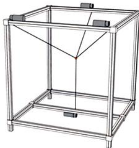
FIG. 2.7 - 3T: Movimento espacial de um ponto
