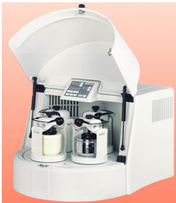
Figura 22 – Fotografia. Vista geral do moinho planetário, marca FRITSCH modelo P5 utilizado para mistura e moagem dos pós de hidreto de titânio e hidreto de nióbio, visando a preparação da liga Ti-35Nb.
