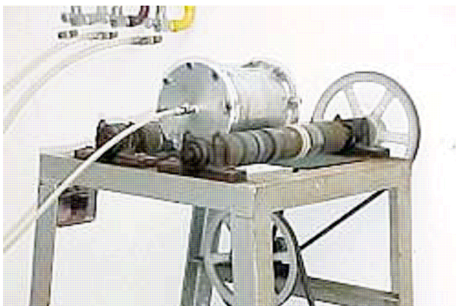
Figura 21 – Moinho de bolas convencional utilizado para moagem dos hidretos de titânio e de nióbio.
