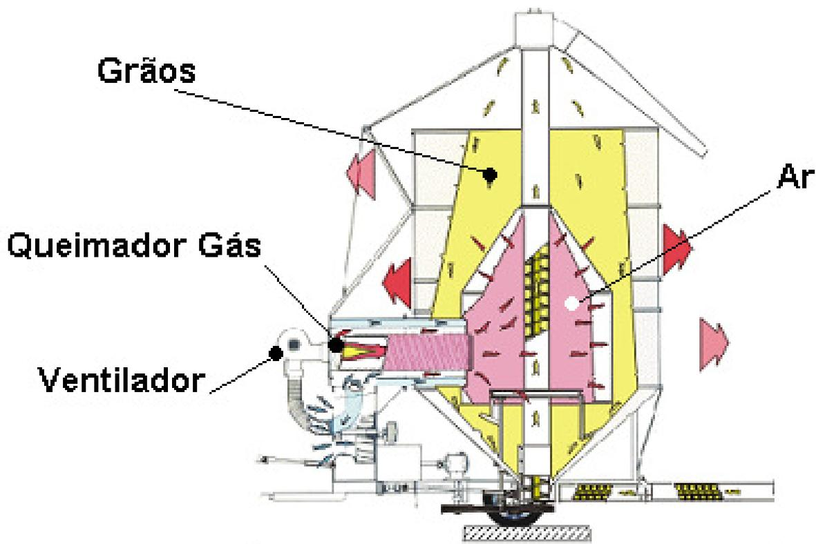
Fig. 4 – Sistema de secagem onde o ar de secagem é insuflado no centro da coluna cilíndrica
