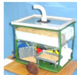
**M9** - Temos a proposta atual, utilizando os princípios do modelo anterior e com dispositivos para viabilizar as operações de carga,descarga, secagem e hogeneização da massa de grãos.A mobilidade do equip. é mantida.(2003)
