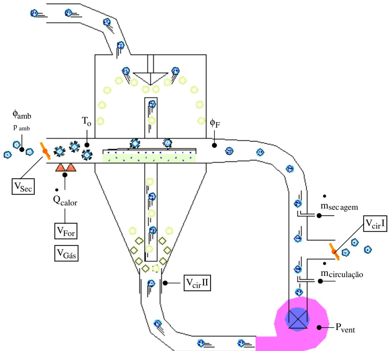
Fig. 87 - Fluxograma do Sistema de Gerenciamento Termodinâmico (S. G. T.)
