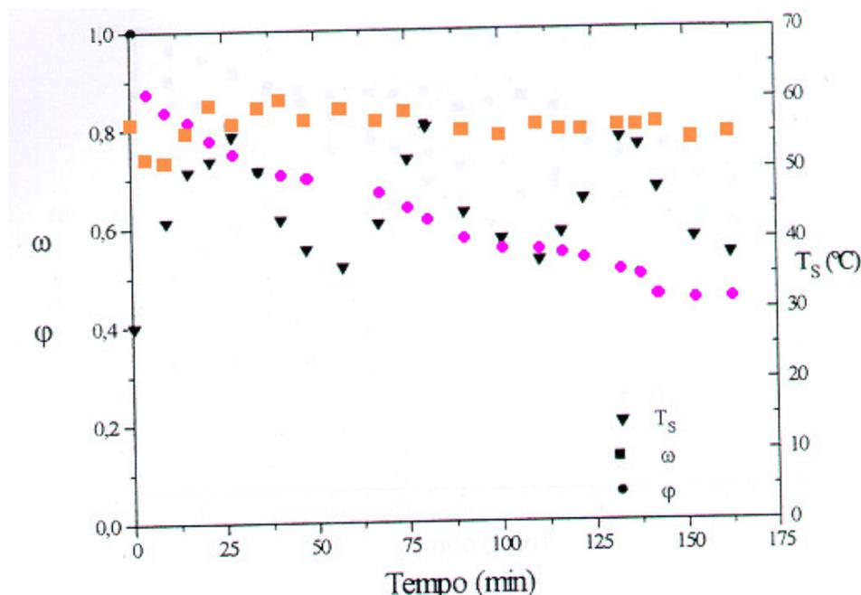
Fig. 10 – Teste de secagem para leito de jorro [Lima, 1997]
