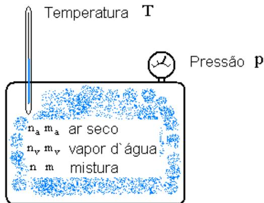
Fig. 24 – Volume contendo ar seco misturado com vapor d' água sob determinada pressão e temperatura.
