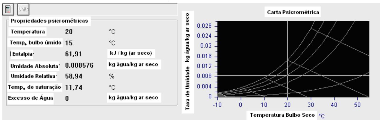
Fig. 32 Ponto (A) – Cálculo das propriedades psicr. do ar ambiente úmido sob  $T = 20\text{ }^{\circ}\text{C}$  e  $T^* = 15\text{ }^{\circ}\text{C}$
