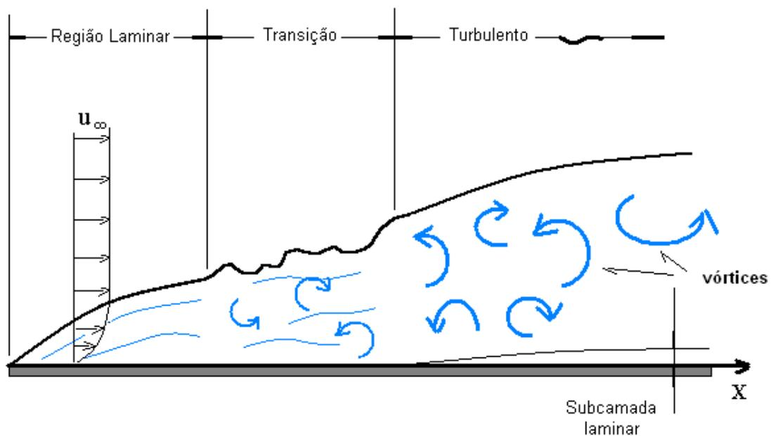
Fig. 38 –Diferentes regimes de escoamento na camada limite sobre uma placa plana [Fox, 1997]
