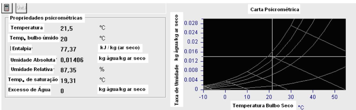
Fig. 34 Ponto (C) – Cálculo das propriedades psicr. ar pós secagem úmido  $T = 21,5\text{ }^{\circ}\text{C}$  e  $T^* = 20\text{ }^{\circ}\text{C}$
