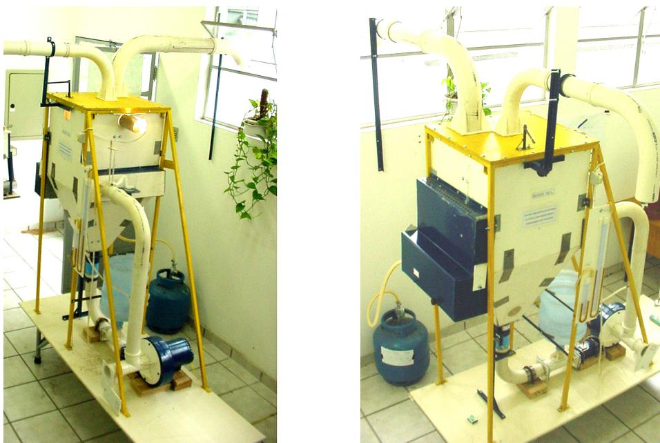
Fig. 61 - Protótipo com capacidade para processar 150 litros de grão.
