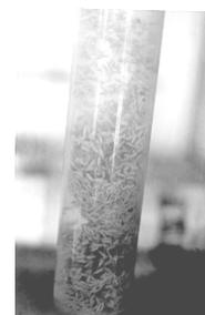
**M3** -Passamos para o laboratório, onde montamos este modelo com objetivo de construir as curvas (Pressão x Vazão) de fluidização (1990)
