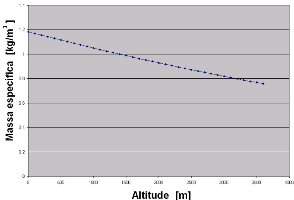
Fig. 36 - Massa específica [kg/m<sup>3</sup>] x Altitude [m] para Ar 25 [o C]
