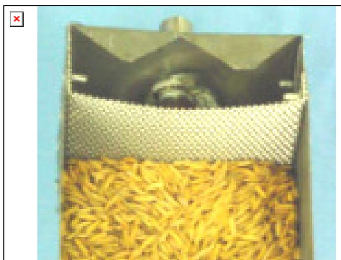
Fig. 57 - Vista interior do volume de 5 litros mostrando a chapa perfurada
