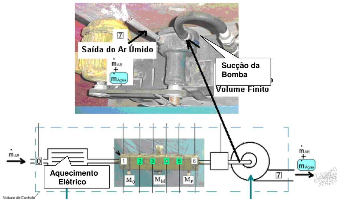
Fig. 58 – Esquema do volume de 5 litros mostrando a bomba de vácuo responsável pela sucção do ar
