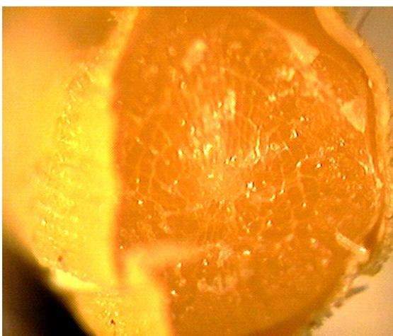
Fig. 43 – Secção transversal de grão de arroz, com 12% de umidade base seca, ampliada 30 vezes
