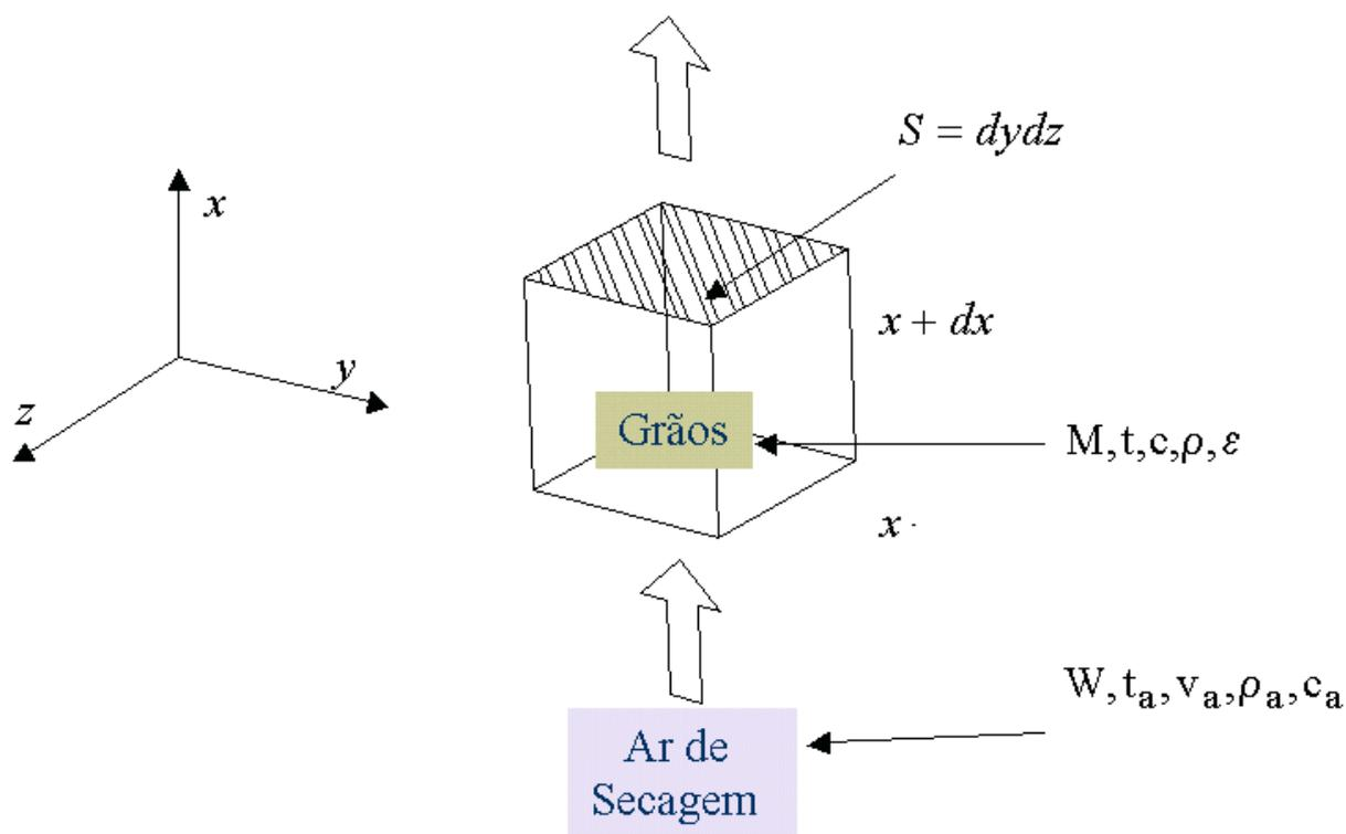
Fig. 51- Volume de controle de formato cúbico cheio de grãos sendo transpassado pelo ar de secagem
