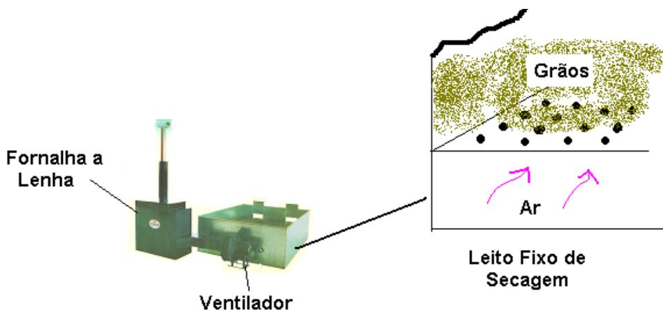
Fig. 3 – Sistema de secagem de grãos com fornalha a lenha e ventilador radial
