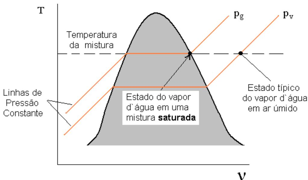
Fig. 25 – Temperatura x volume específico ar úmido [Shapiro, 1998].
