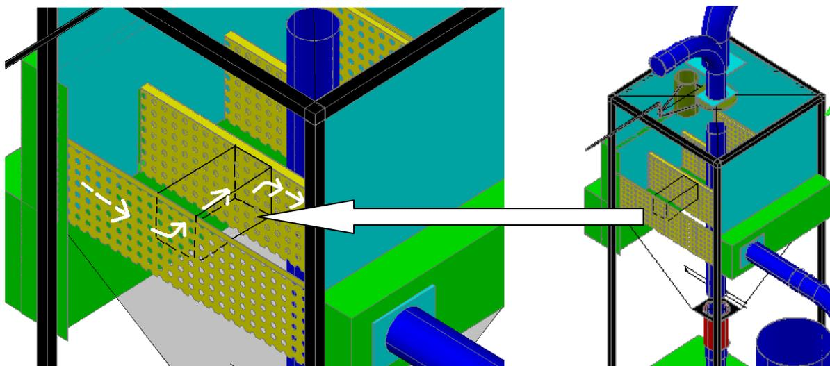
Fig. 53 – Localização do secador protótipo de 5 litros entre as passagens de ar do sistema de 150 litros
