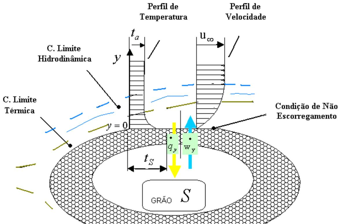
Fig. 40 – Camada Limite Térmica e Hidrodinâmica formando-se sobre a superfície de um grão
