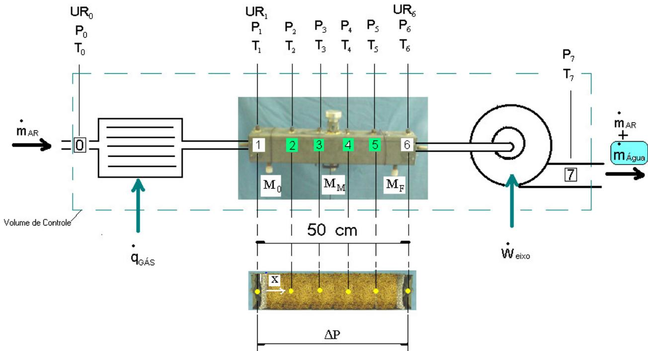
Fig. 62 - Fluxograma do secador protótipo para secagem de 5 litros de grãos.
