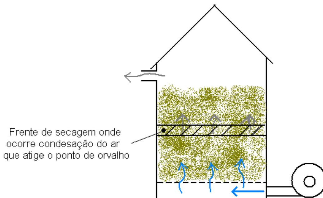
Fig. 26 – Esquema de silo com a frente de secagem em progressão [Weber, 2005]
