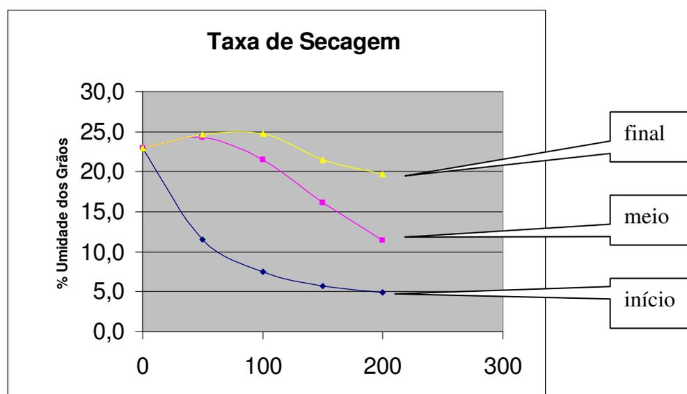
Fig. 115- Curvas de umidade dos grãos – Teste N. 5
