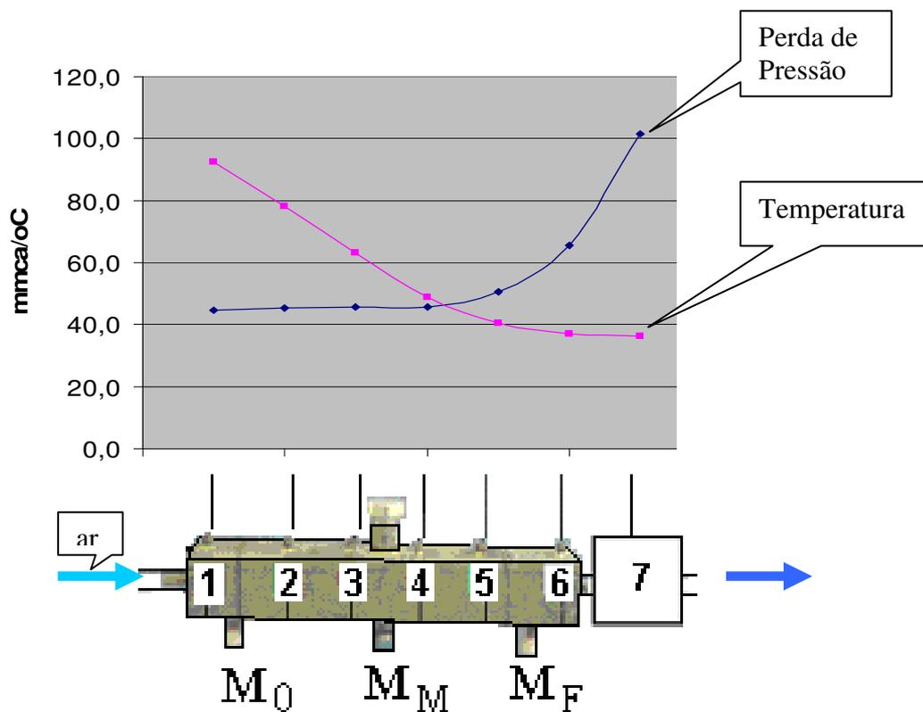
Fig. 110 - Distribuição de pressões e temperaturas do teste N. 4
