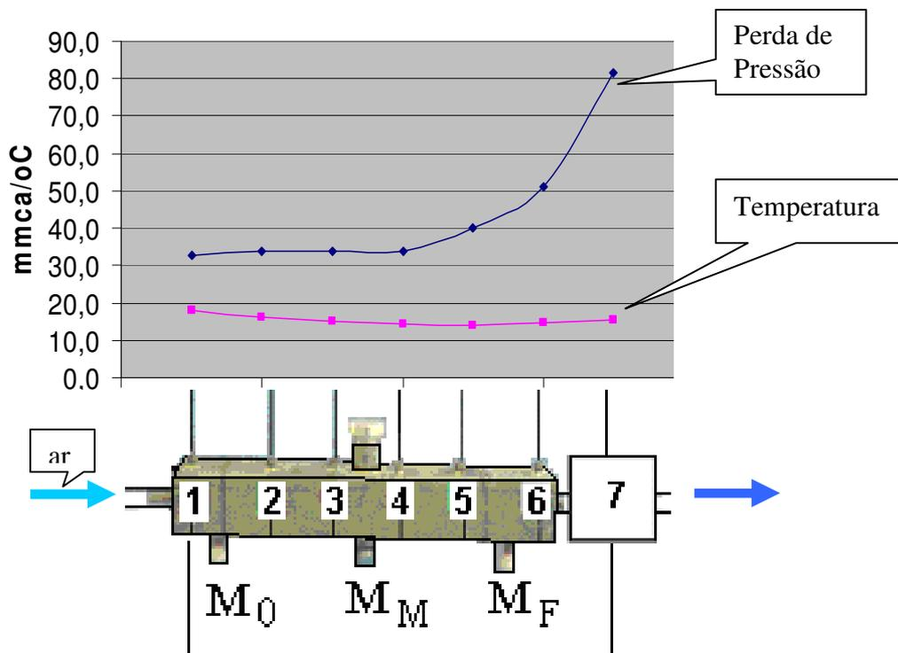
Fig. 106- Distribuição de pressões e temperaturas do teste N. 3
