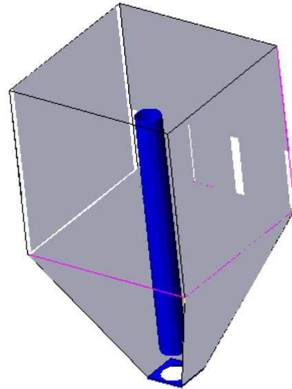
Fig. 9 – Leito de secagem cúbico de base piramidal
