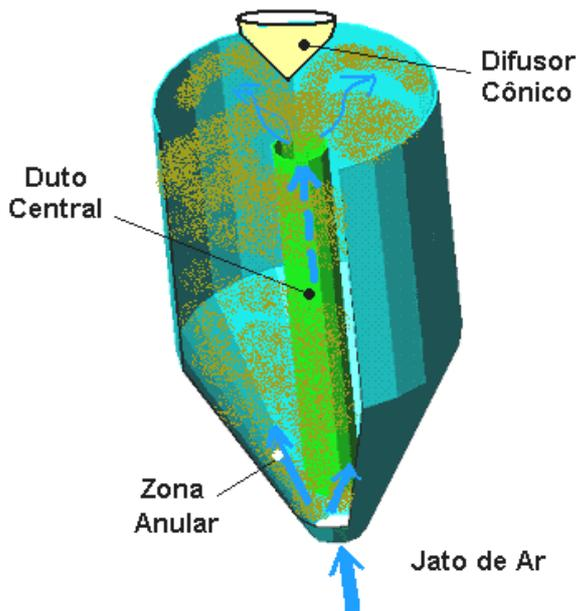
Fig. 8 – Leito de secagem cilíndrico base cônica
