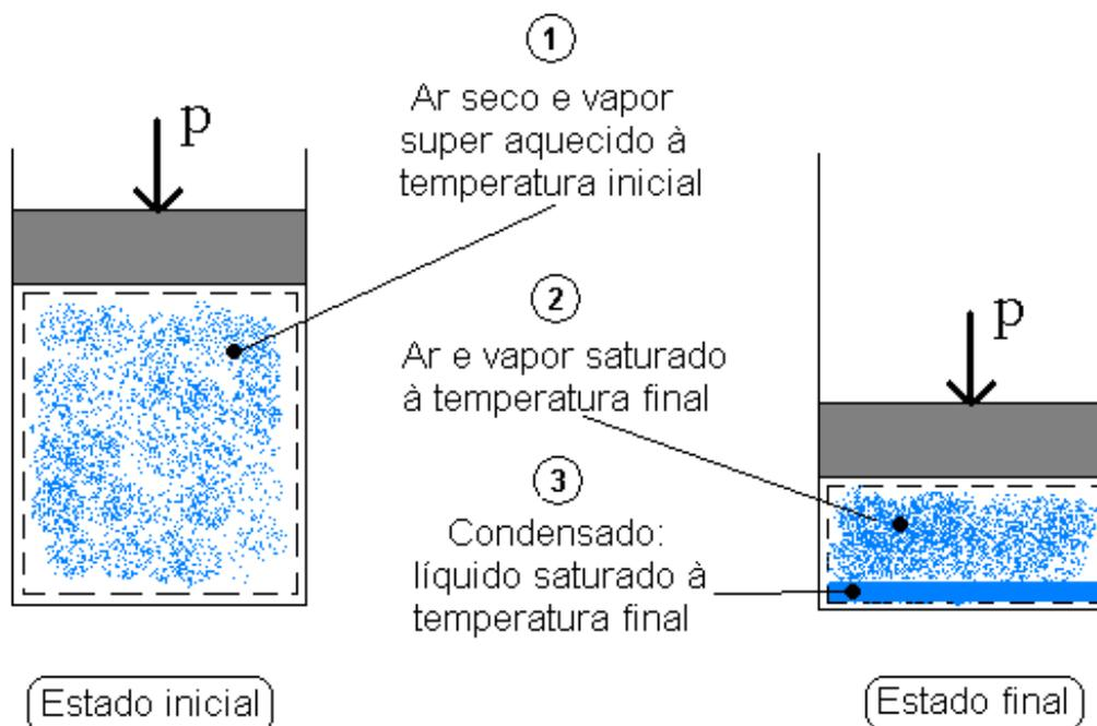
Fig. 27 – Resfriamento de ar úmido a pressão constante [Shapiro, 1998].
