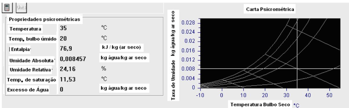
Fig. 33 Ponto (B) – Cálculo das propriedades psicr. ar ambiente aquecido sob  $T = 35\text{ }^{\circ}\text{C}$  e  $T^* = 20\text{ }^{\circ}\text{C}$
