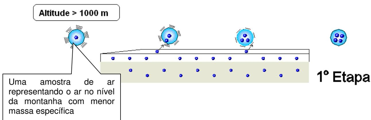
Fig. 47 – Ilustração para uma amostra de ar de baixa massa específica escoando sobre a superfície do grão
