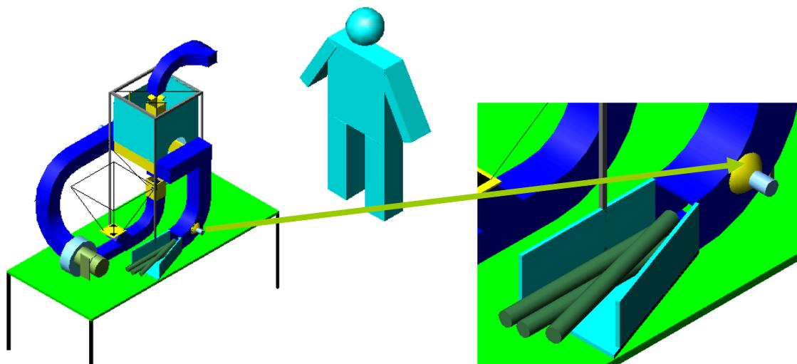
Fig. 120 – Sistema de secagem com dispositivos vibro-acústicos na região de combustão da biomassa
