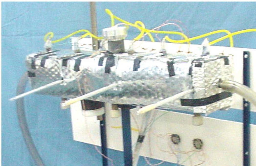
Fig. 56 – Termômetros inseridos no volume de 5 litros de grãos
