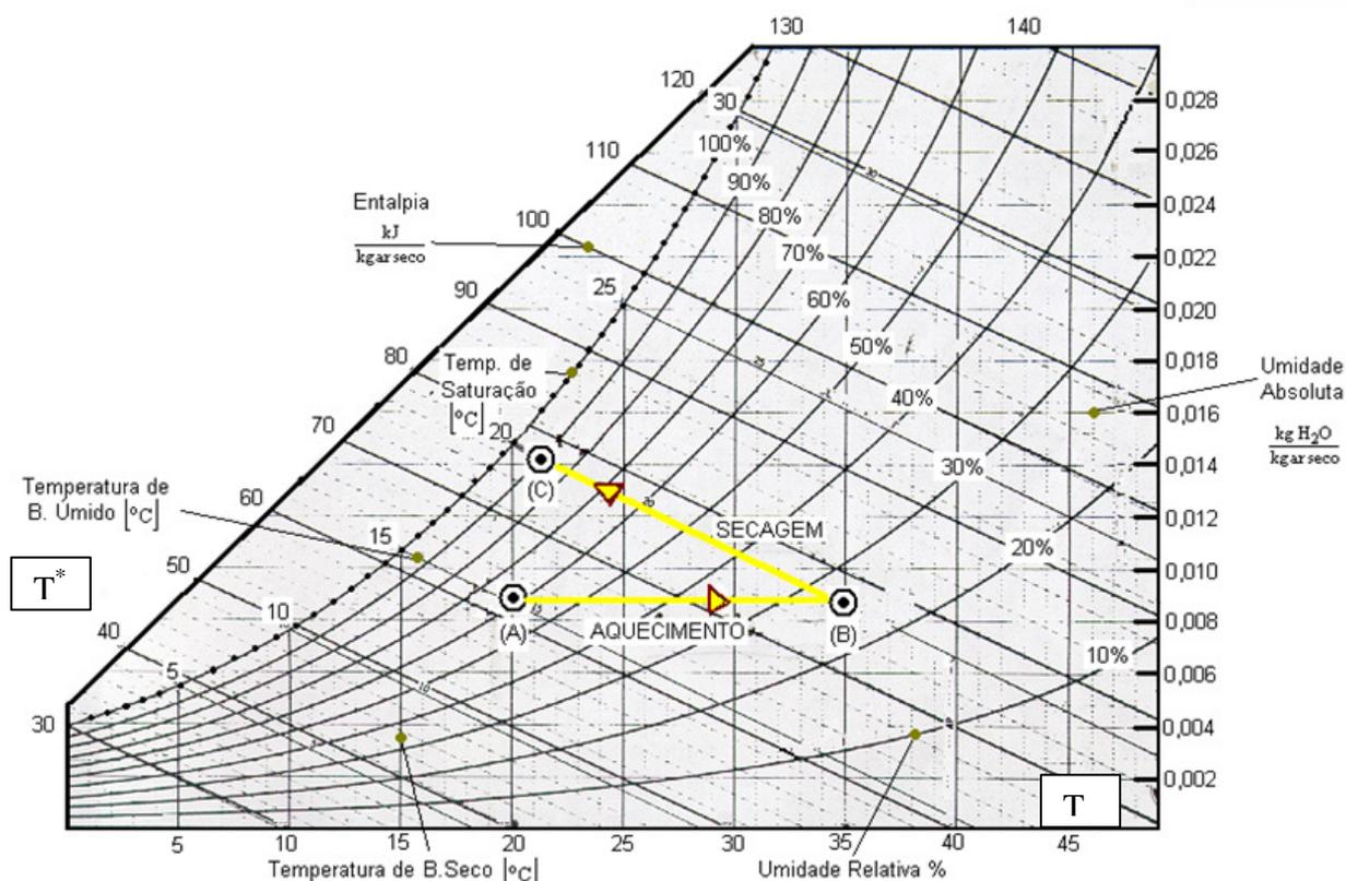
Fig 31. Carta psicrométrica ilustrando o processo de secagem adiabático na primeira etapa do processo
