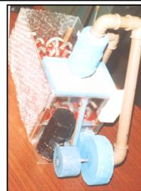
**M7** -Continuamos com leitos de jorro , porém com todos os jorros concatenados em uma sequência única, forçando os grãos a seguir um "caminho"dentro do secador.(2002)
