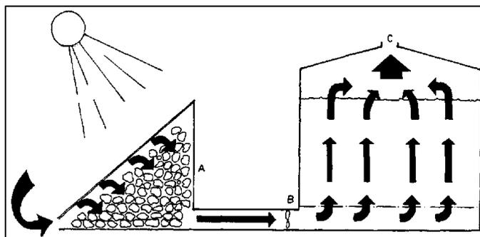
Fig. 2 – Sistema de secagem de grãos com aquecimento solar indireto
