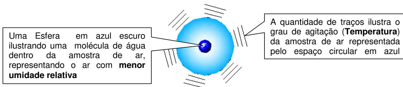
Fig. 45 – Ilustração para uma amostra de ar em alta temperatura e com uma molécula de água
