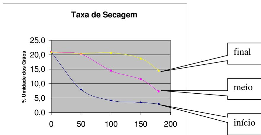
Fig. 111 - Curvas de umidade dos grãos – Teste N. 4
