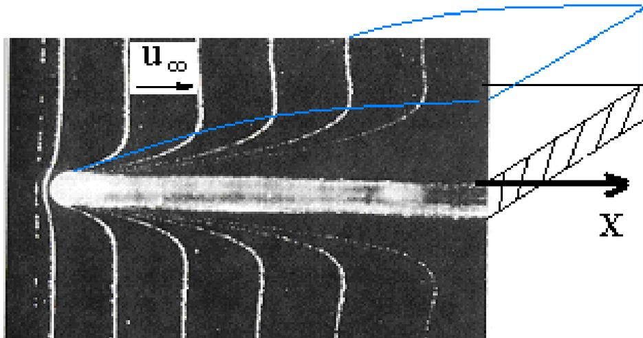
Fig. 39 - Fluxo de água salgada através de placa plana - formação das camada limite laminar [Fox, 1997]
