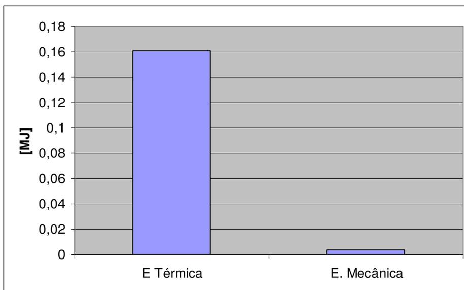
Fig. 109 - Gráfico comparativo do consumo de energia térmica e mecânica do teste N. 4
