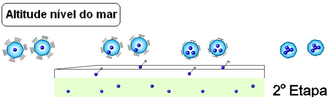
Fig. 48 – Ilustração para amostra de ar escoando sobre o grão e retirando moléculas de água da estrutura interna
