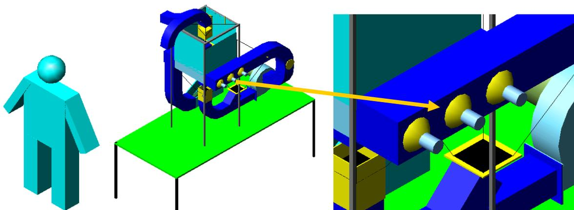
Fig. 119 – Sistema de secagem com dispositivos vibro-acústicos na região de escoamento do ar de secagem
