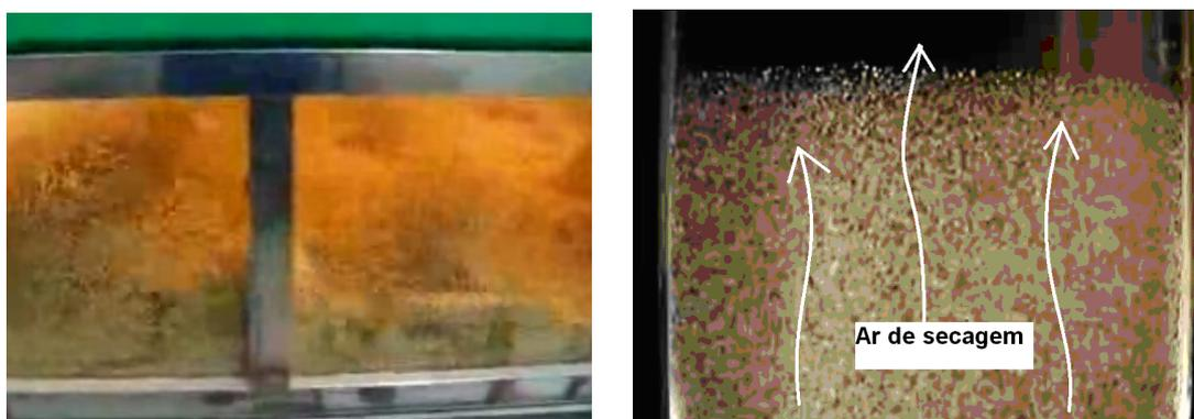
Fig. 23 – Fotos de leito fluidizado e leito fixo
