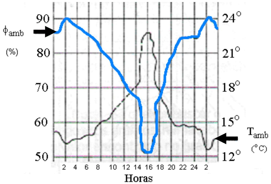
Fig. 50 - Variação da temperatura e umidade relativa do ar ambiente ao longo de 24 horas [Weber, 2005]
