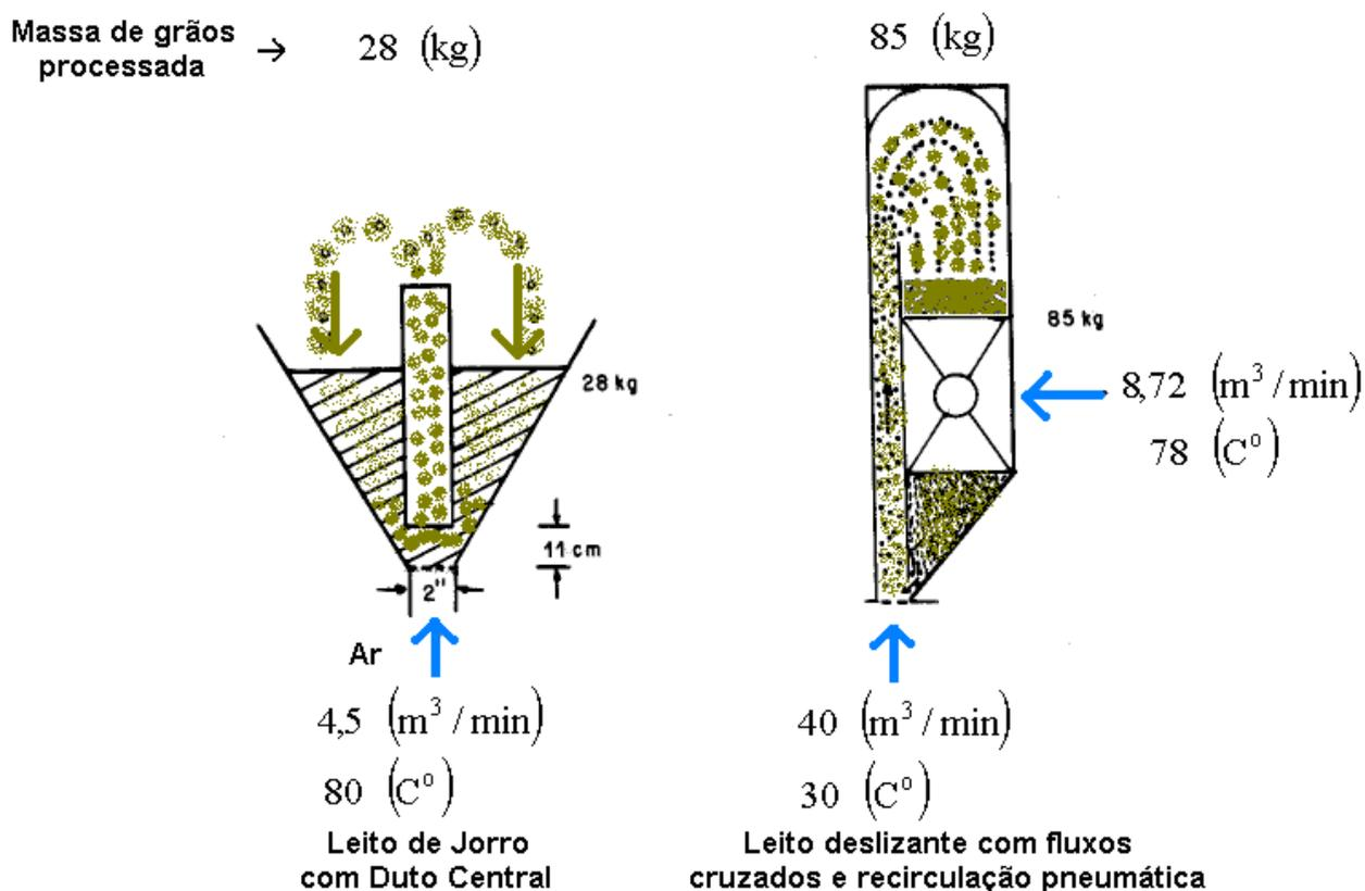
Fig. 14 – Diagrama esquemático dos Leitos de Jorro e Deslizante
