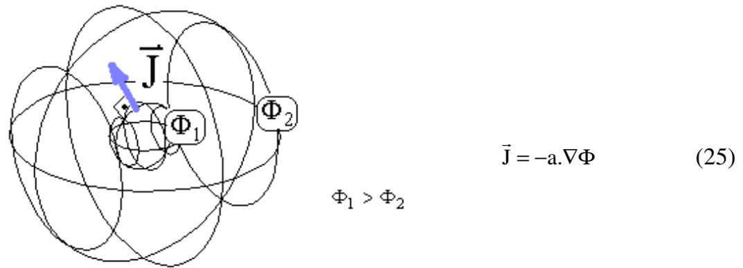
Fig. 37 - Representação geométrica para níveis de potencial esféricos e equação correspondente
