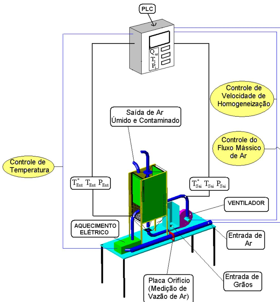
Fig. 91 – Secador protótipo para caracterização dos grãos
