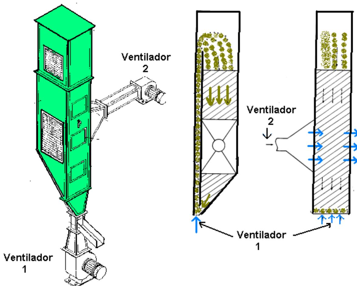
Fig. 11 – Sistema de secagem com leito deslizante, fluxos cruzados e recirculação pneumática
