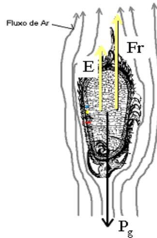
Fig. 127– Grão de arroz em suspensão no escoamento de ar
