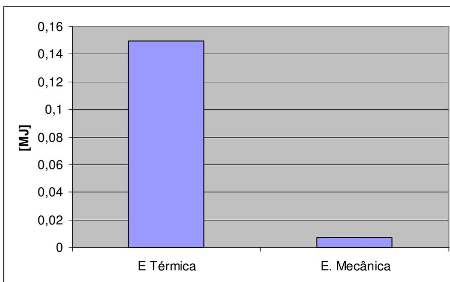
Fig. 113- Gráfico comparativo do consumo de energia térmica e mecânica do teste N. 5
