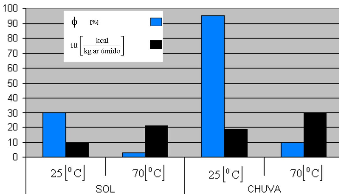
Fig. 49 - Valores de Entalpia (Ht) e Umidade Relativa ( $\Phi$ ) do ar de secagem dia de sol e de chuva para Guaratinguetá Altitude: 572 m  $P_{atm}$ : 712 [mmHg]
