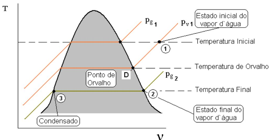
Fig. 28 – Diagrama  $T \times V$  - temperatura / volume específico [Shapiro, 1998].
