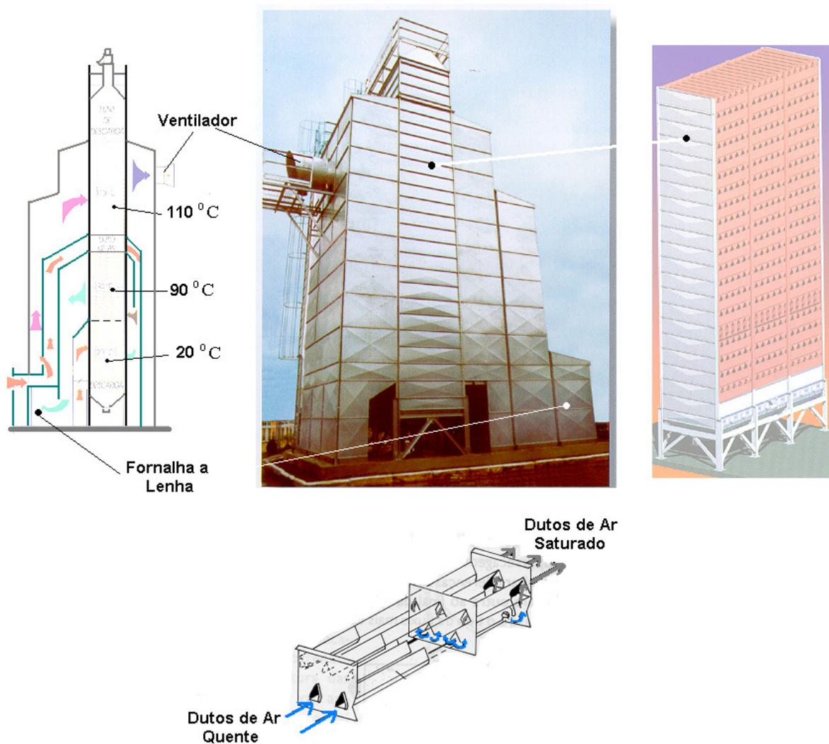
Fig. 7 – Sistema de secagem de grande porte (10. 000 kg /h) com vários estágios de temperatura.
