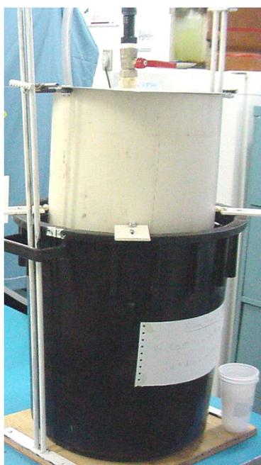
Fig. 59 – Gasômetro para medição de volume de ar
