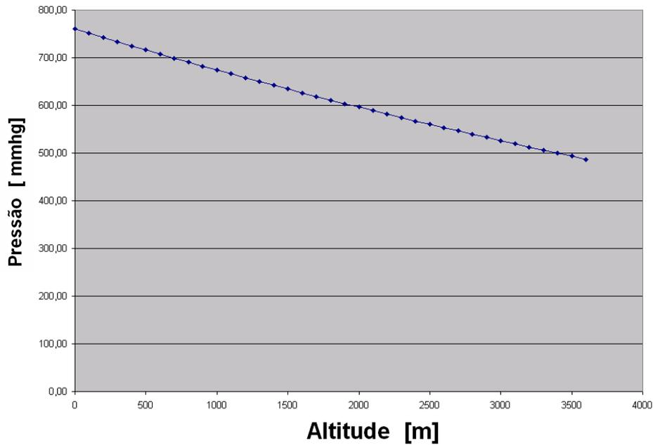
Fig. 35 - Pressão Atmosférica [mmHg] x Altitude [m]
