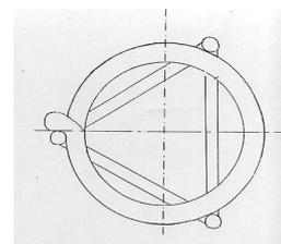
**M4-** Este modelo seria um leito tubular com fluidização interna dos grãos, estes desceriam por gravidade até o ponto inferior do equipamento. (1991)
