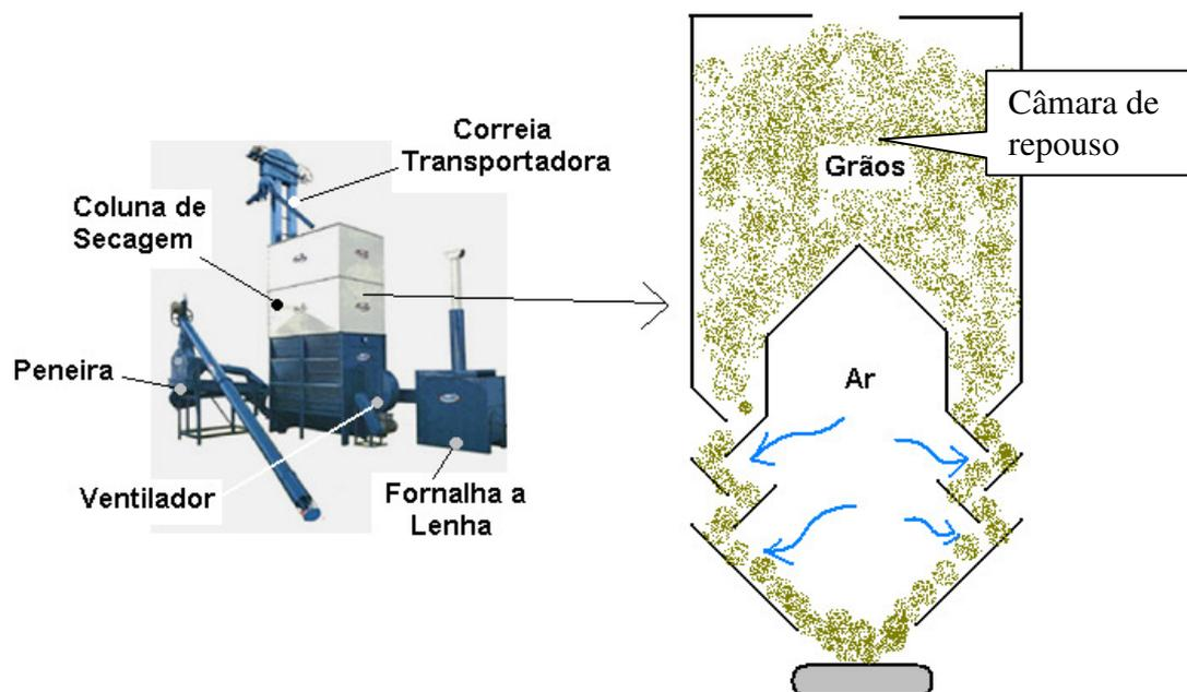
Fig. 6 – Sistema de secagem com câmara de repouso para os grãos
