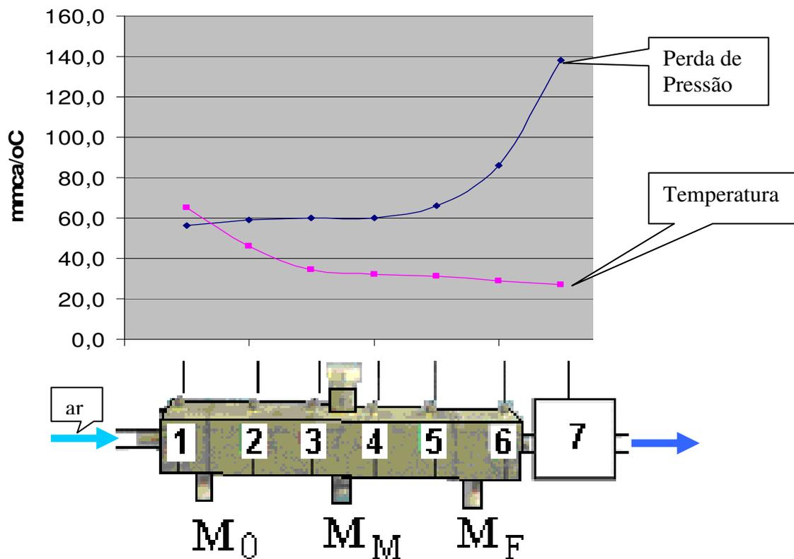
Fig. 114- Distribuição de pressões e temperaturas do teste N. 5
