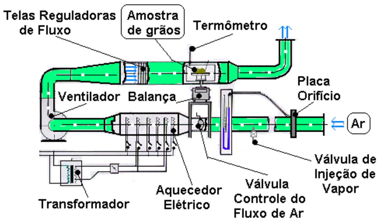
Fig. 15 – Croqui do sistema experimental de investigação da cinética da secagem [Mujundar, 1995]
