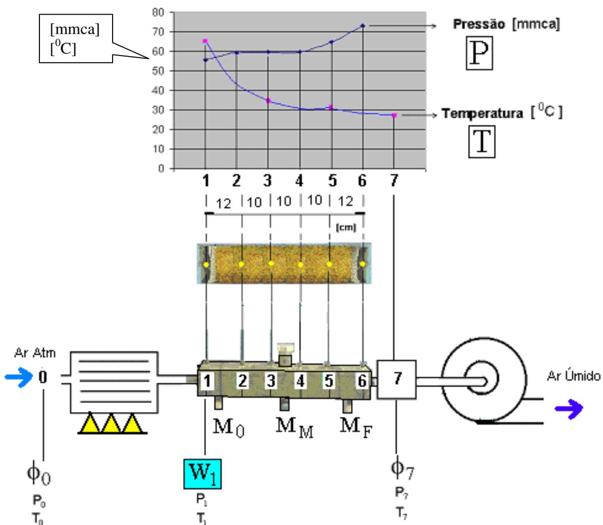
Fig. 103 - Secador protótipo 5 litros de grãos com pontos de coleta de amostras, medidas (P, T) e gráfico.
