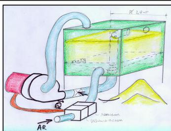
**M8**-A proposta é obter um leito fixo sob baixa pressão do fluxo de ar de secagem,favorecendo assim o mecanismo de secagem.(2003)
