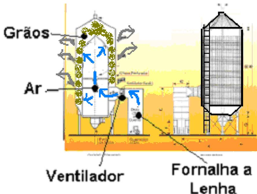
Fig. 5 – Sistema de secagem com coluna cilíndrica
