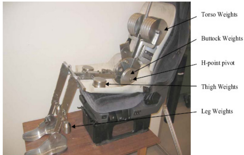
Figura 13: Equipamento utilizado na medição do ponto H (posição do torso; posição da bacia; eixo do ponto H; posição da coxa e posição da perna). Fonte: Volvo (julho de 2007)
