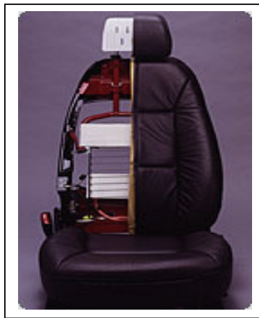
Figura 18: Estrutura interna de um assento automobilístico Fonte: Guia de Mecânica 2, da Revista quatro rodas
