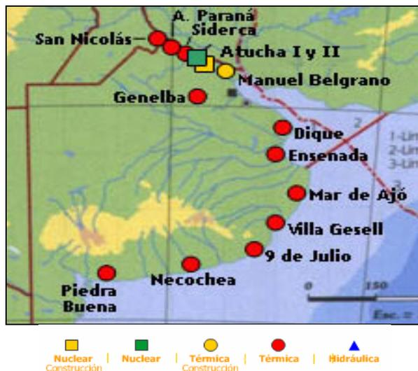
Figura 3.7. Centrais elétricas na Província de Buenos Aires. Fonte: CAMMESA 2008.
