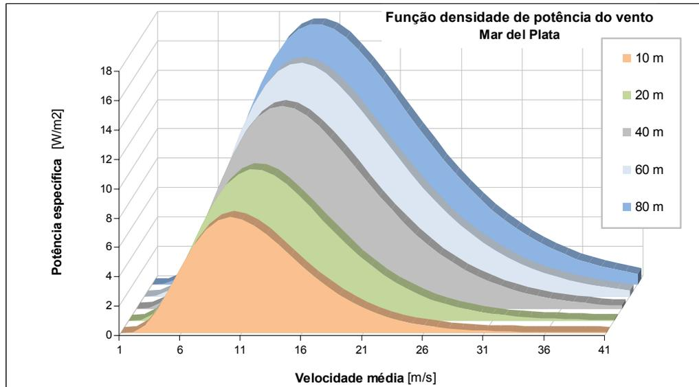
Figura 5.10. Densidade de potência disponível no vento por altura. Mar del Plata. Fonte: elaboração própria.
