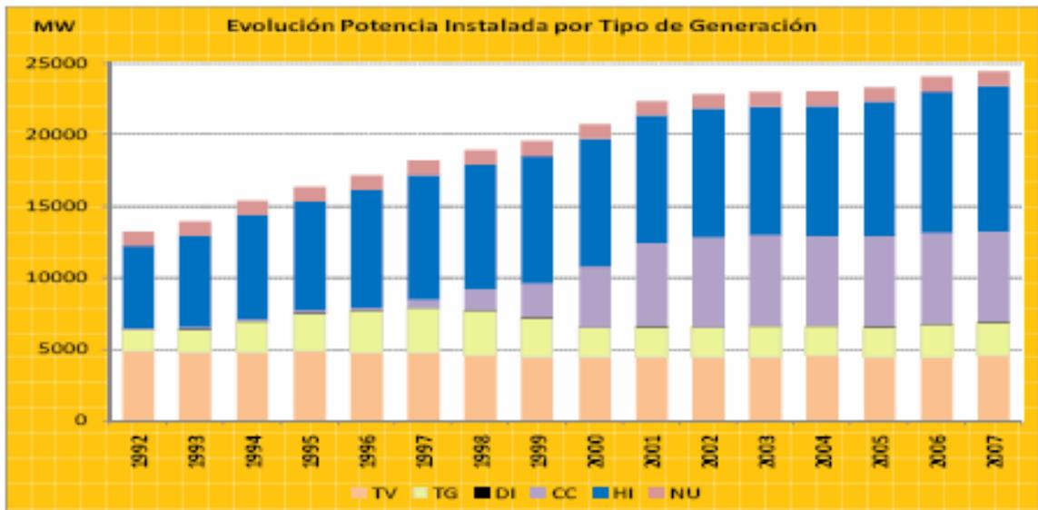
Figura 3.2. Evolução da potência instalada por tipo de geração. Fonte: CAMMESA 2008.
