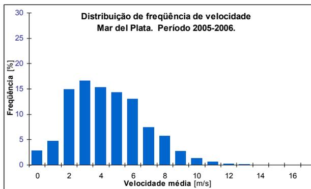
Figura 6.14. Distribuição de frequência por velocidade. Mar del Plata. Fonte: Elaboração própria.
