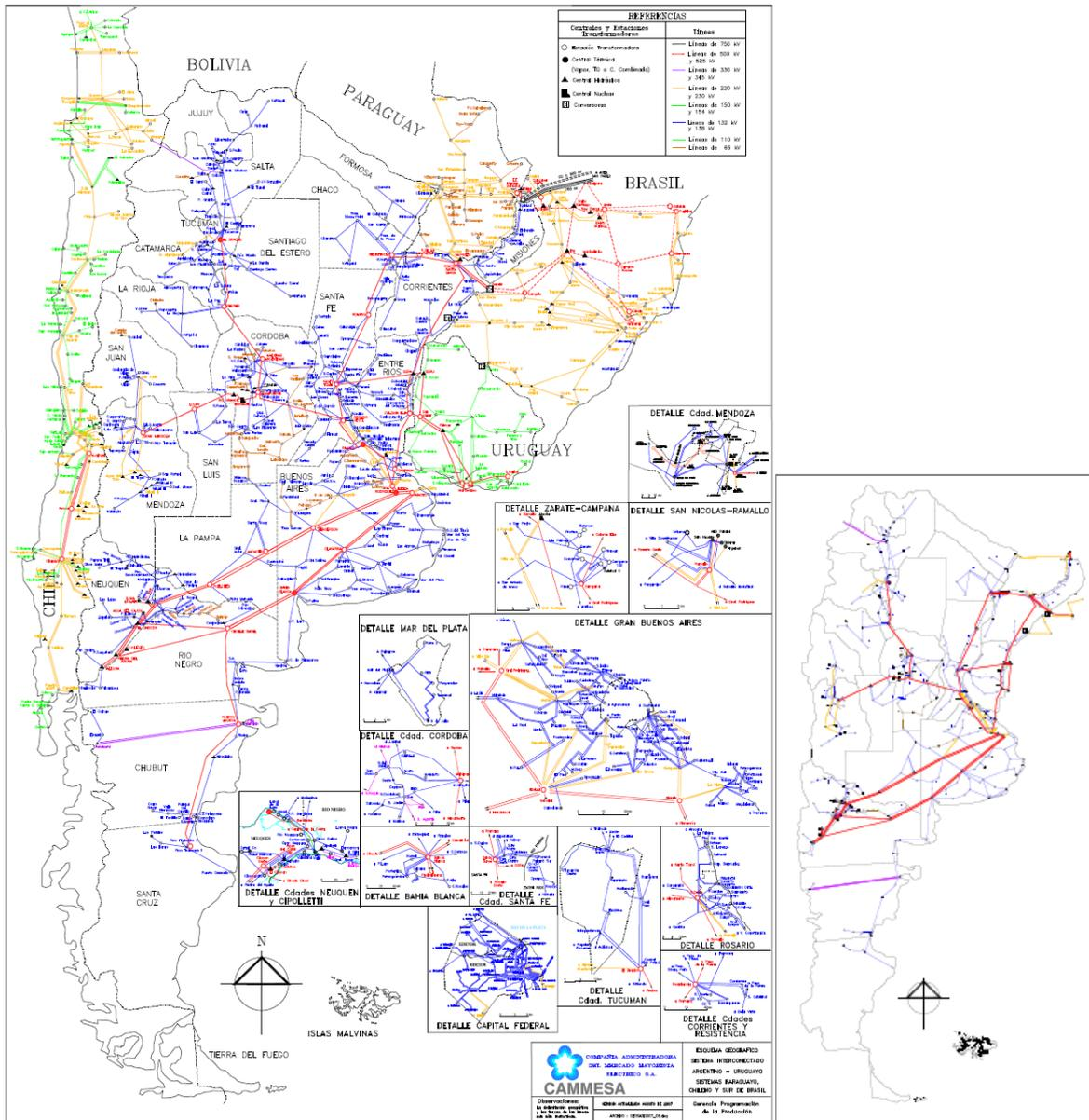
Figura 3.5. Redes elétricas no Sistema Interconectado Nacional. Linhas em 132 kV (azul) e as de 500 kV (vermelho). Fonte: CAMMESA 2008.
