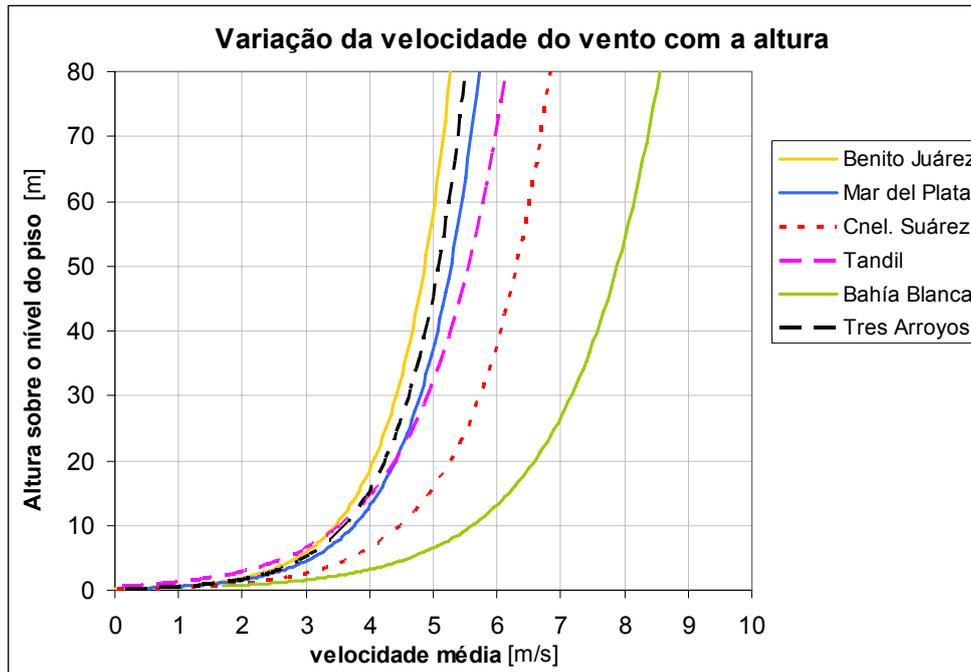
Figura 5.8. Variação da velocidade de vento com a altura. Fonte: Elaboração própria.
