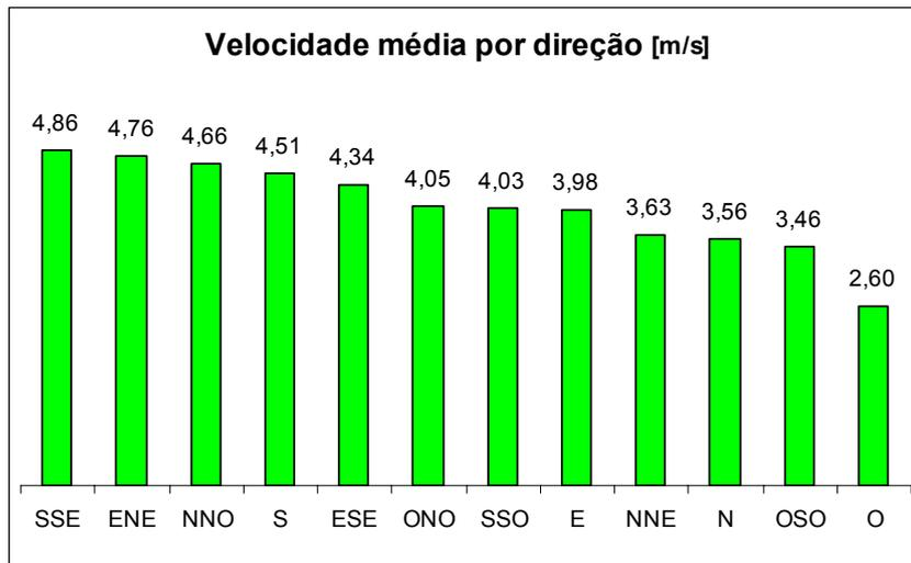
Figura 6.4. Velocidade média por direção. Fonte: Elaboração própria.
