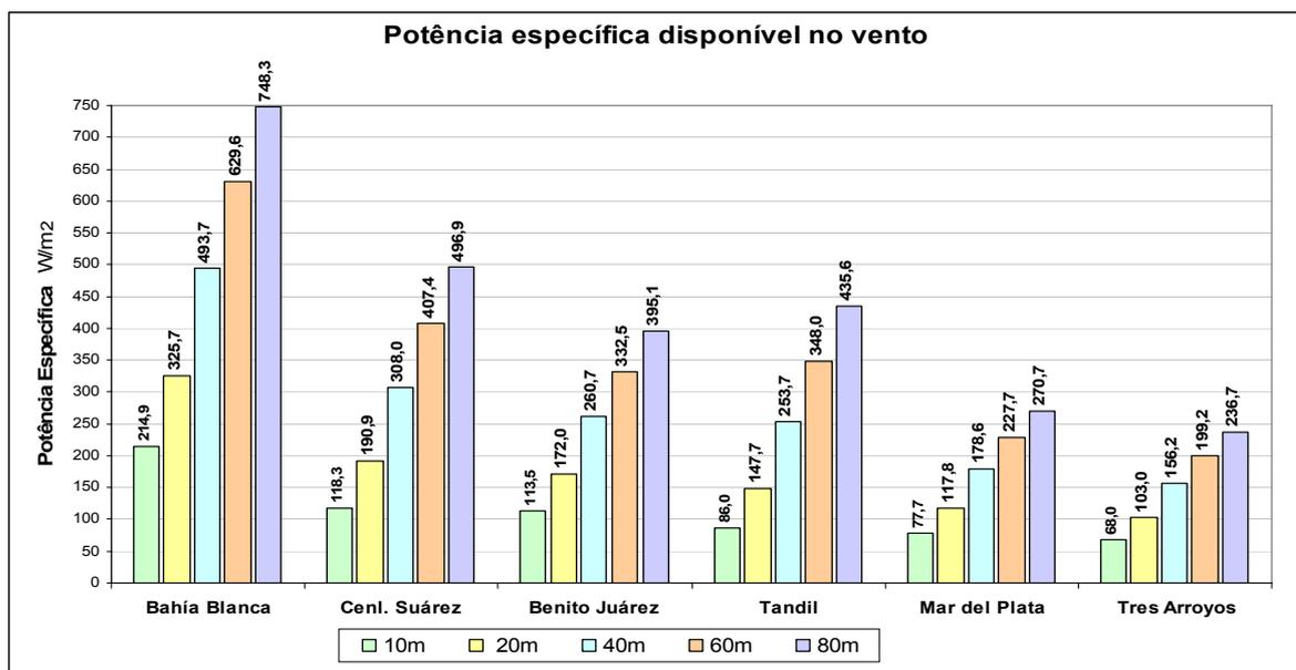
Figura 5.9. Potência específica para os diferentes pontos de medição. Fonte: elaboração própria.
