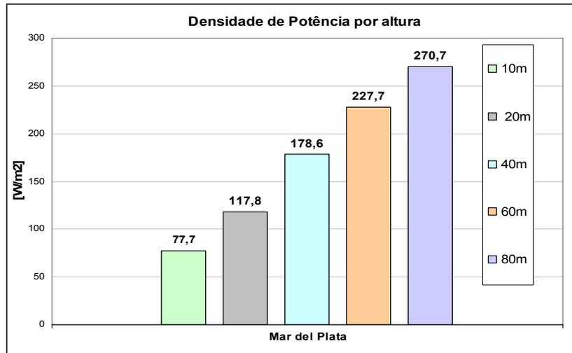
Figura 6.20. Variação da densidade de potência com a altura. Fonte: elaboração própria.
