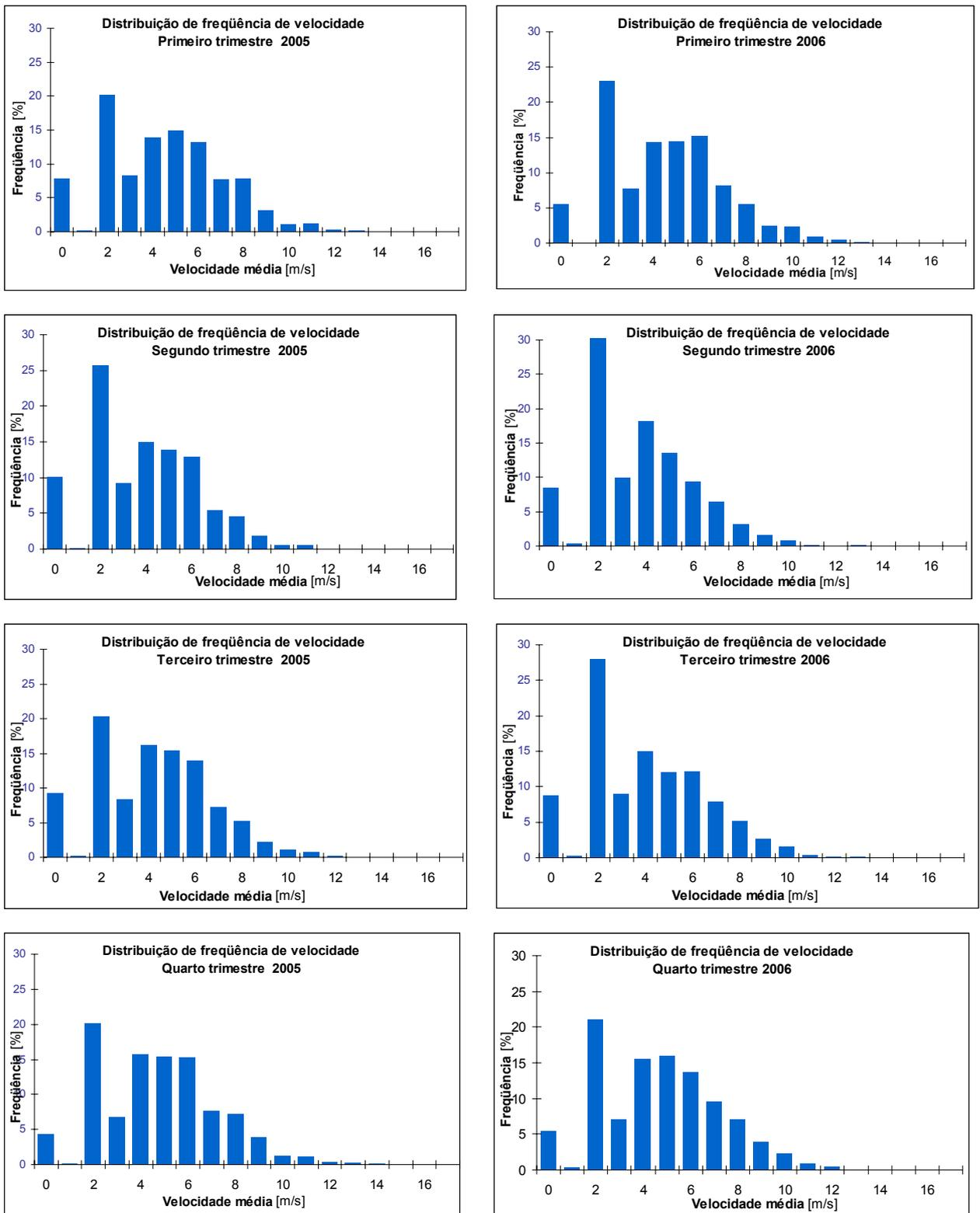
Figura 5.3. Distribuição de frequência de velocidade para diferentes trimestres. Mar del Plata. Fonte: Elaboração própria.
