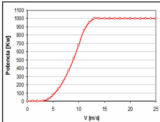
Figura 6.23. Curva de geração da turbina eólica. Fonte: Enercon.
