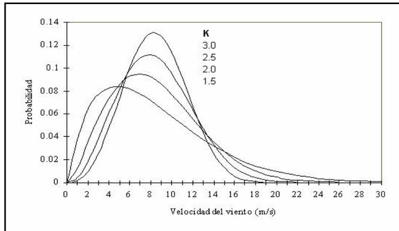
Figura 4.1. Gráfico de Weibull em função do fator de forma “k”. Fonte: UNAM,1998.
