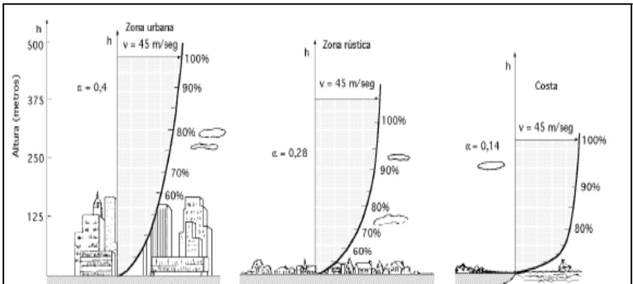
Figura 4.2. Variação da velocidade do vento com a altura. Fonte: Fernández Diez, 2003.
