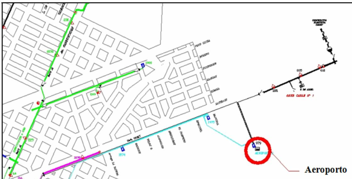
Figura 6.11. Detalhe do sistema de 13,2 kV com ponto de interligação - zona Aeroporto. Fonte: EDEA, 2008.
