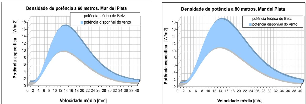
Figura 5.11. Densidade de potência disponível e densidade de potência teórica (Betz). Mar del Plata. Fonte: Elaboração própria.
