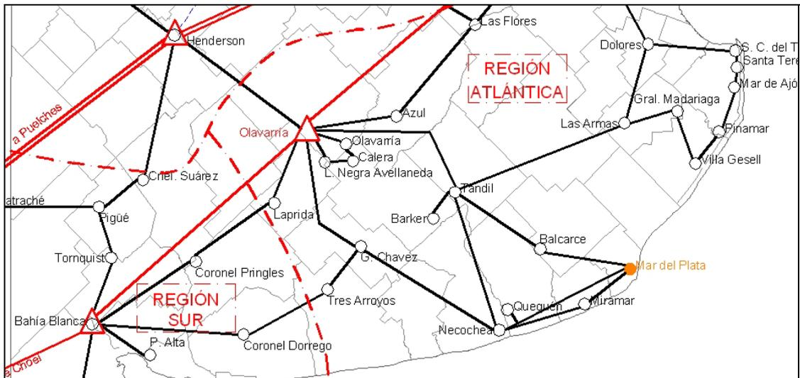
Figura 6.10. Esquema das linhas elétricas 132 kV (negro) e 500 kV (vermelho). Fonte: Transba S.A.
