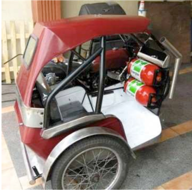
Fig. 1.2: Veículo de duas rodas filipino adaptado para utilização de GNA pela Energtek
