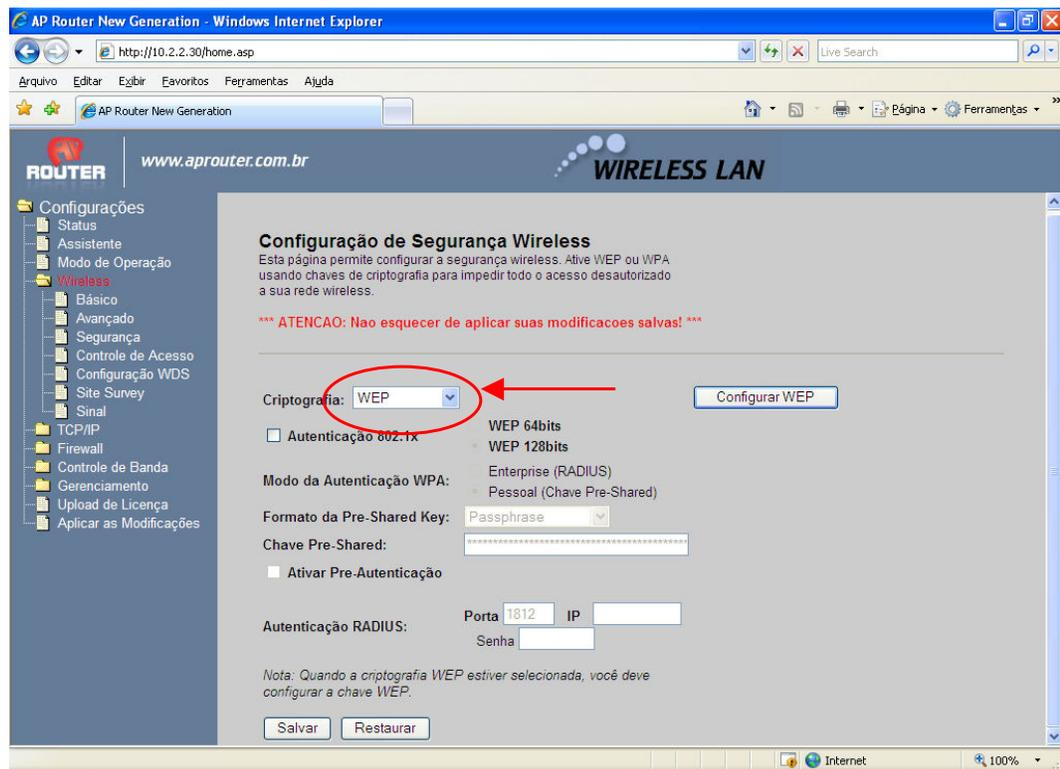
Figura 03 - Configuração do AP com protocolo WEP habilitado
