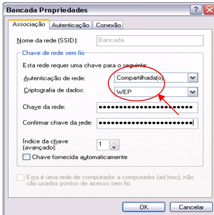
Figura 04 - Configuração da STA 01 com WEP habilitado
