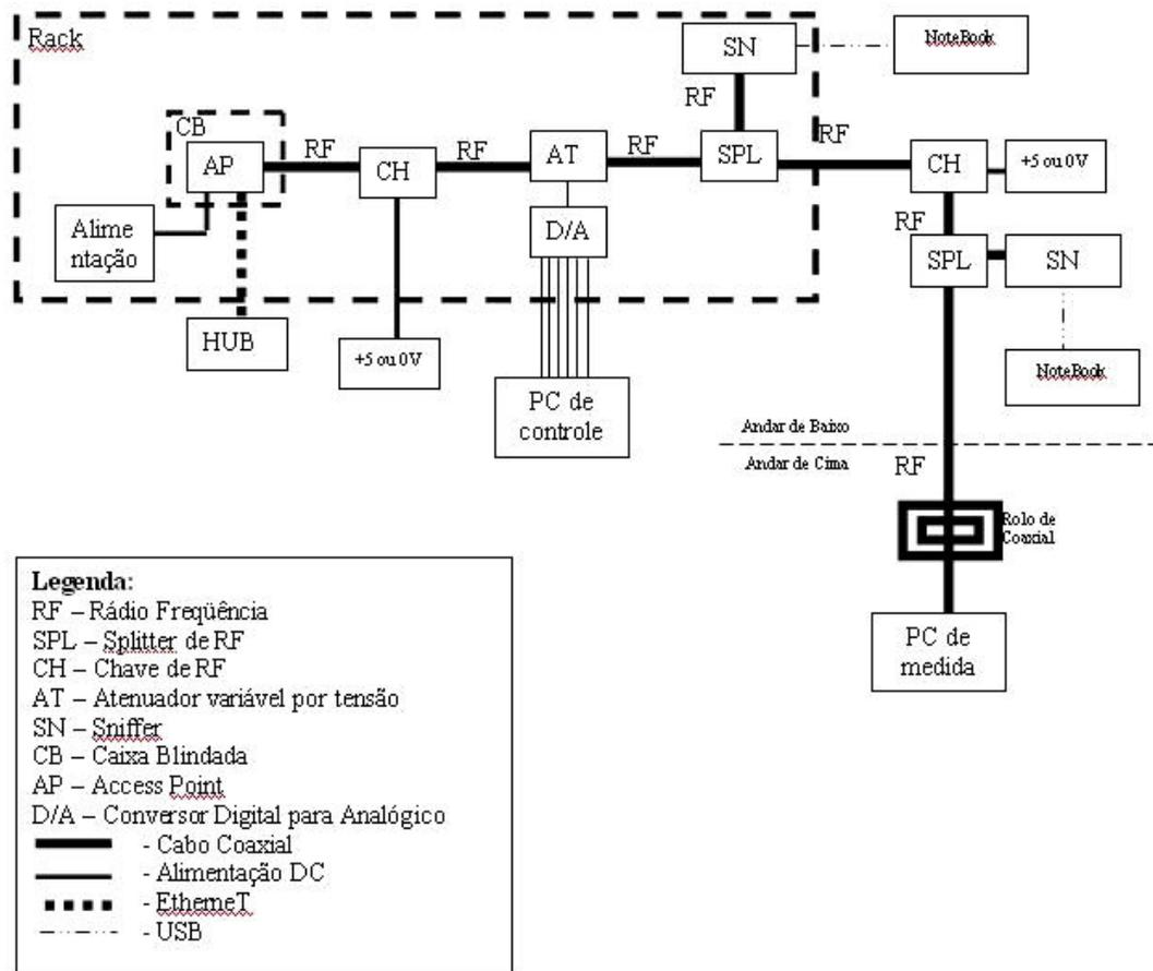
Figure 1: Diagrama em blocos da bancada de emulação.
