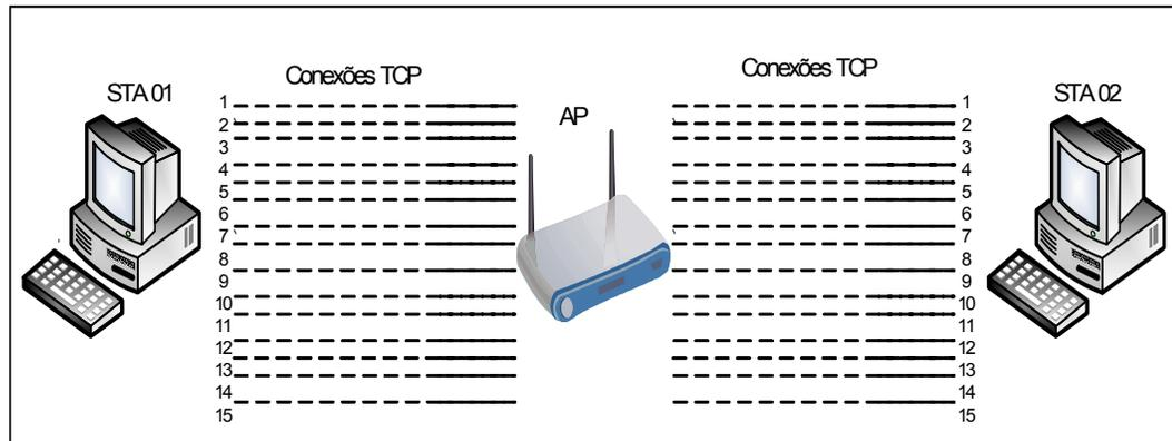
**Figura 25 – Conexões TCP estabelecida entre os equipamentos da WLAN**
