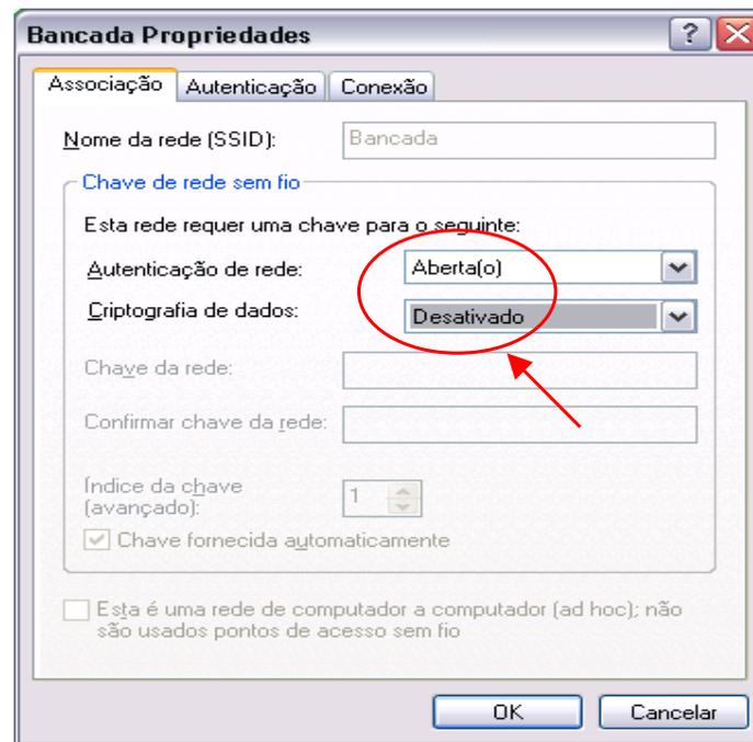
**Figura 02 - Configuração da STA 01 sem segurança**
