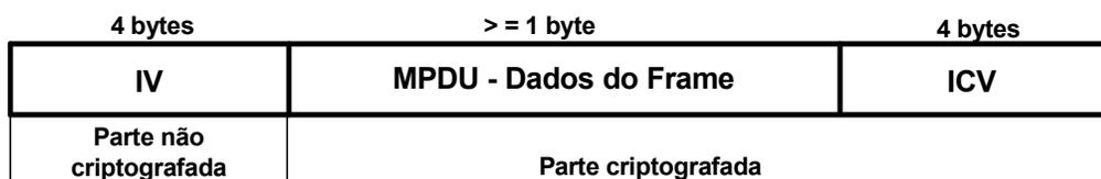
**Figura 5 – Frame original expandido para o frame WEP**
