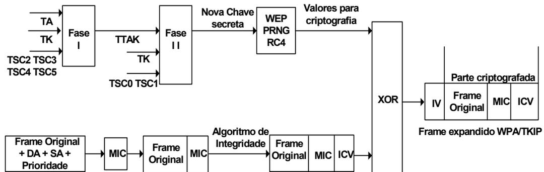
**Figura 10 – Diagrama do processo de criptografia WPA/TKIP**
