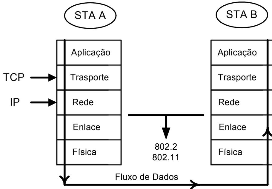
**Figura 3 – Fluxo de dados na pilha TCP/IP**
