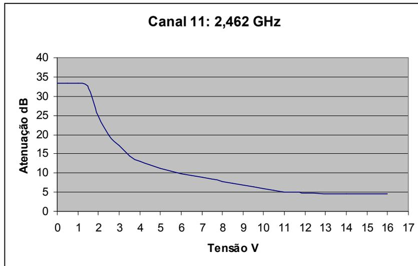
**Figura 10: Curva do atenuador variável para o canal 11.**
