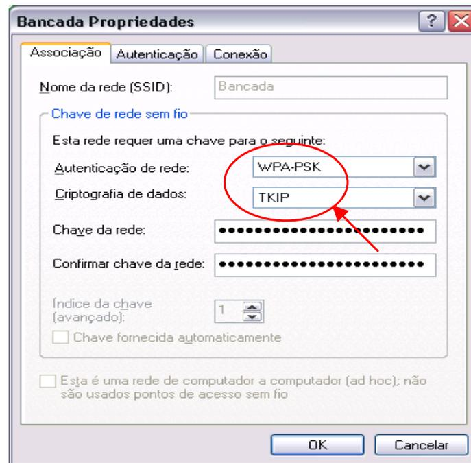
**Figura 06 - Configuração da STA 01 com WPA/TKIP habilitado**
