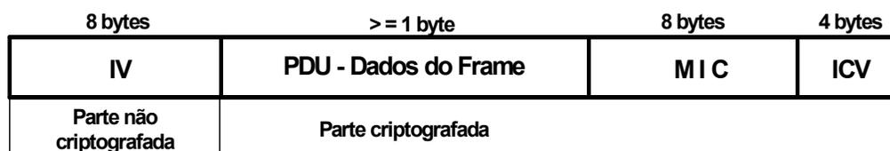
**Figura 8 – Frame original expandido para o frame WPA/TKIP**
