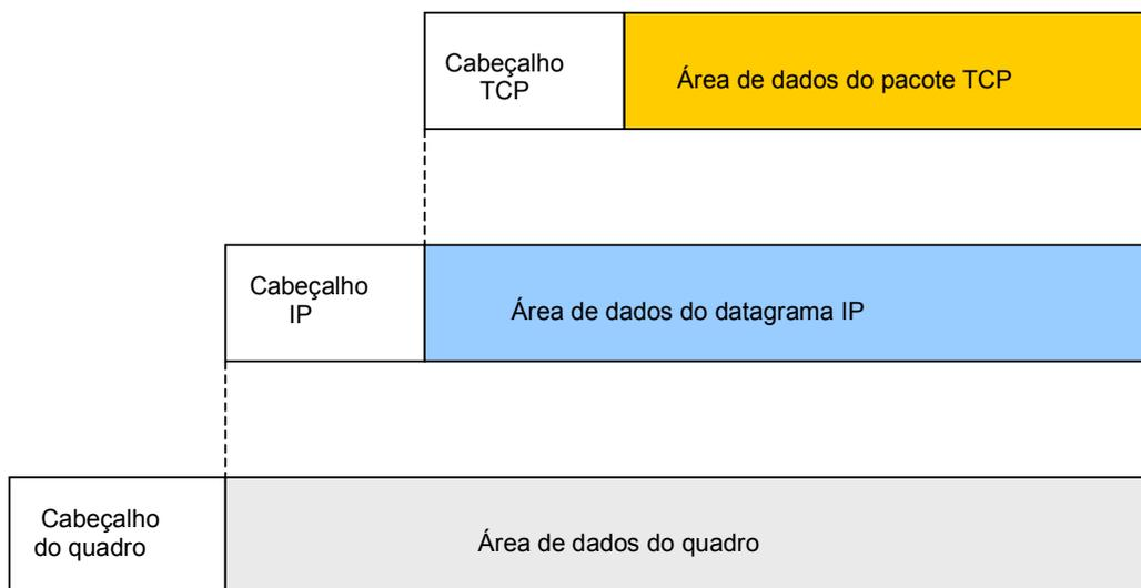
**Figura 12 – Encapsulamento do protocolo de dados do TCP**
