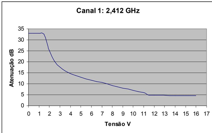
**Figura 8: Curva do atenuador variável para o canal 1.**
