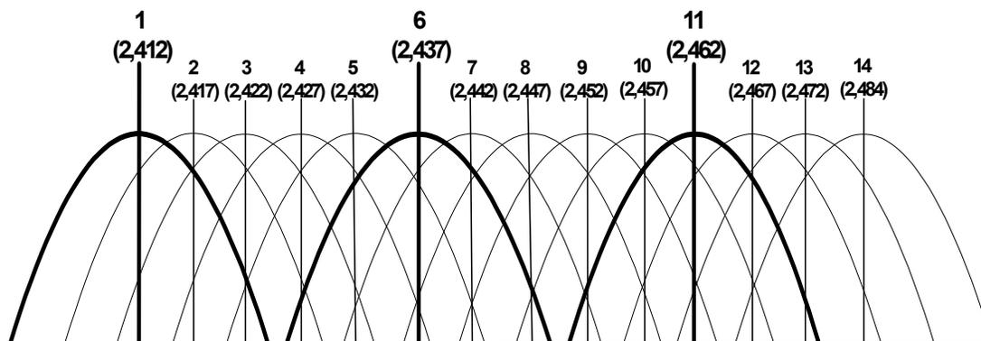
**Figura 4 – Espaçamento mínimo entre os canais DSSS**
