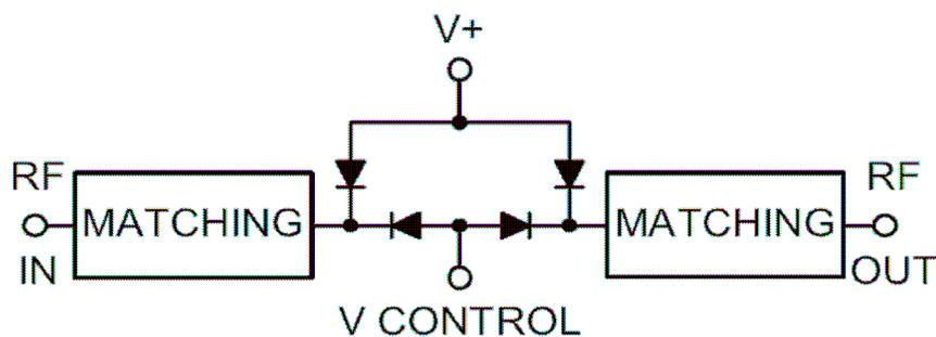
Figura 2: Circuito de atenuador variável
