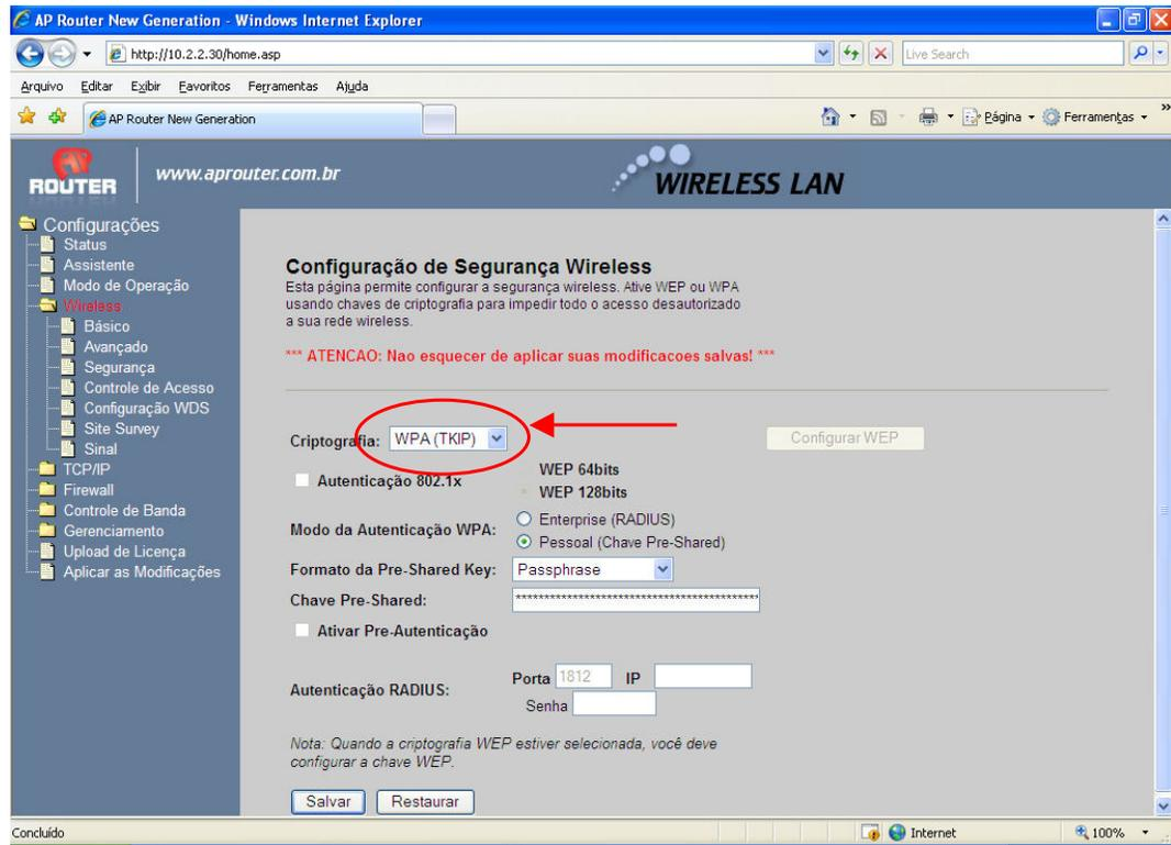
Figura 05 - Configuração do AP com protocolo WPA/TKIP habilitado
