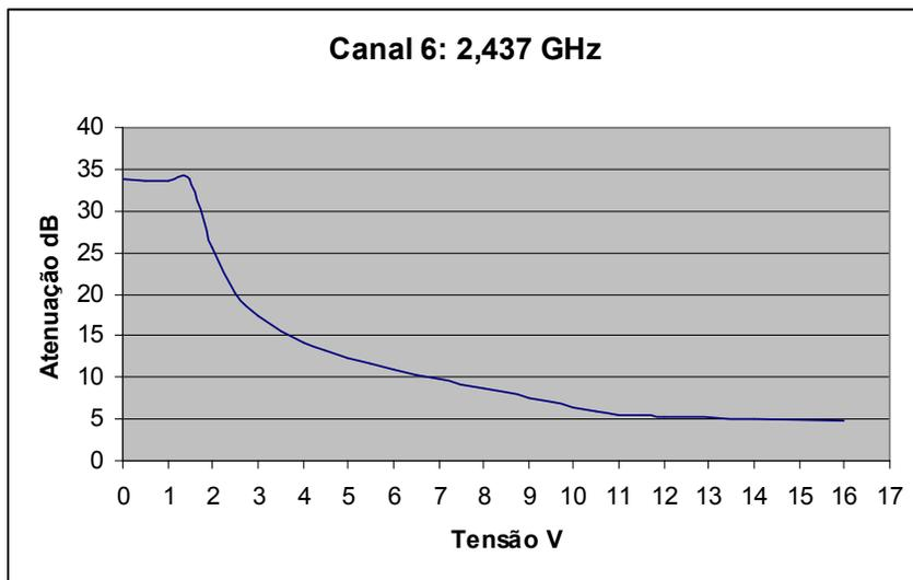
**Figura 9: Curva do atenuador variável para o canal 6.**
