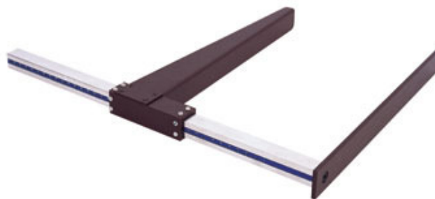
Figura 2 - Caliper abdominal portátil ( Holtain Kahn Abdominal Caliper ® ) utilizado para aferição do diâmetro abdominal sagital.
