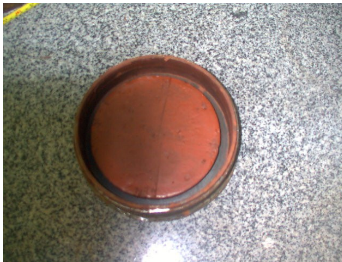
Figura 3.9: Final do ensaio de contração livre
