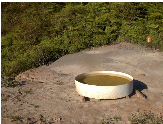
Figura 3.31: Tanque de evaporação
