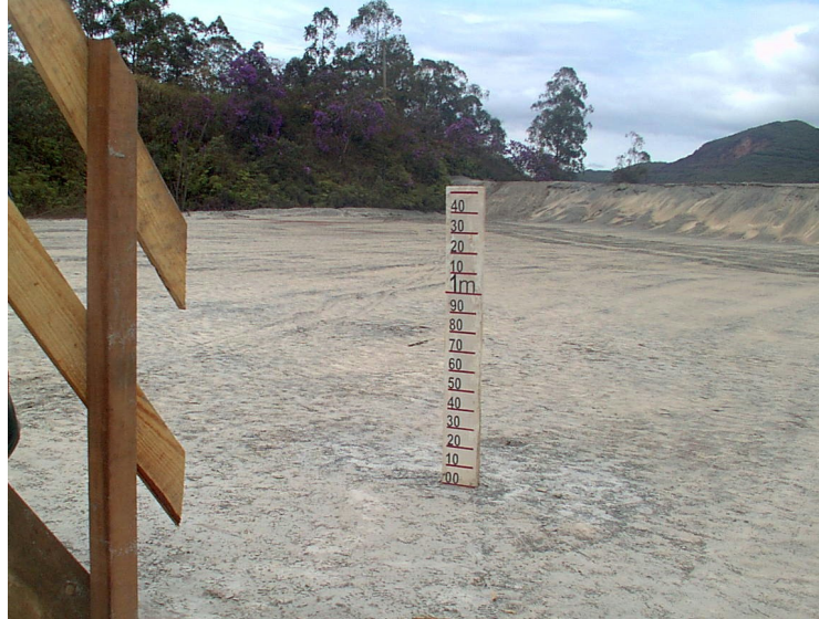
Figura 3.29: Régua graduada para medir o recalque
