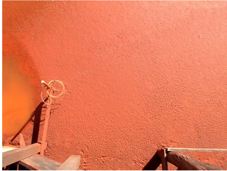
Figura 3.39: Vista do tensiômetro da base após o enchimento da área teste
