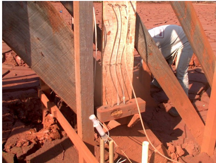
Figura 3.41: Sistema de leitura dos tensiômetros
