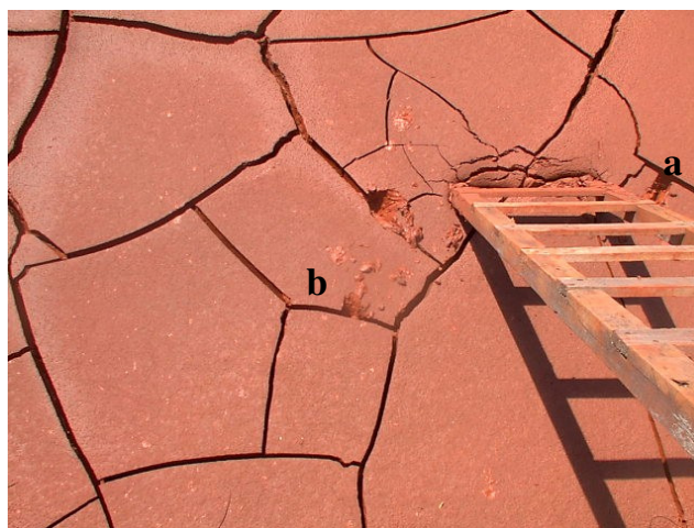
Figura 4.11: Trincas a e b no dia 92
