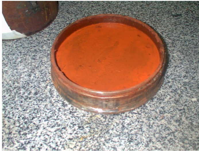
Figura 3.8: Ensaio de contração livre
