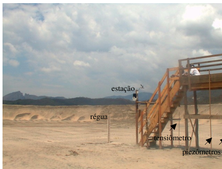
Figura 3.34: Instrumentos instalados antes do enchimento da área teste
