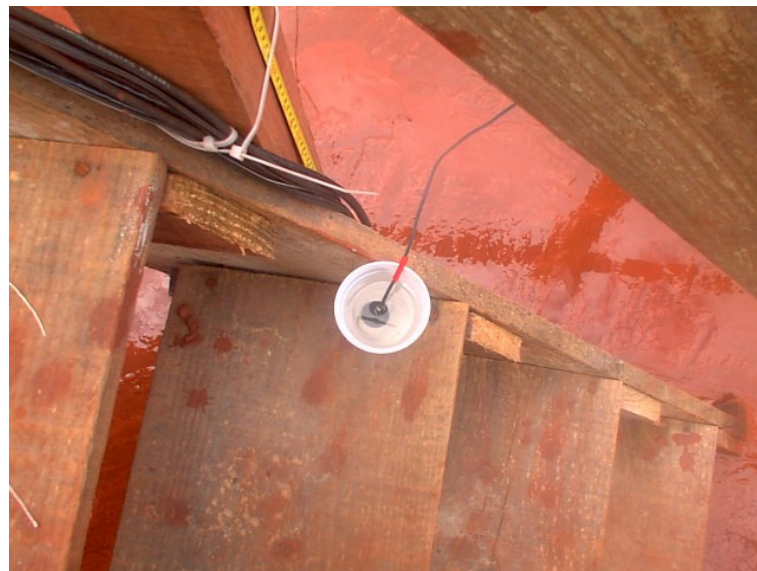
Figura 3.35: Saturação do sensor de sucção
