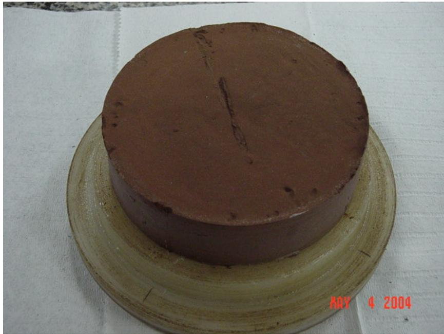
Figura 3.15 – Amostra de lama na fase final do ensaio da contração livre.
