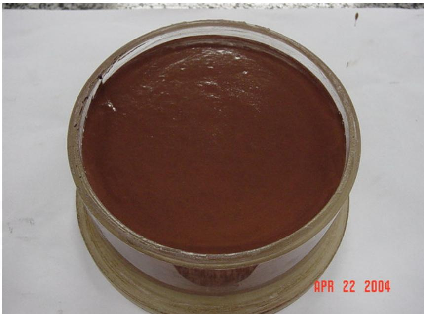
Figura 3.13 – Topo da amostra exposto às condições de temperatura do laboratório.
