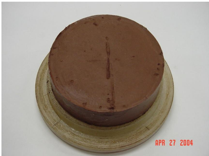
Figura 3.14 – Topo/lateral amostra expostos às condições de temperatura do laboratório.
