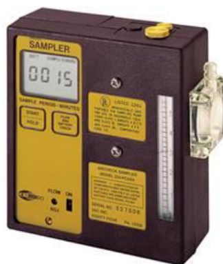
Figura 23 - Foto da bomba de ar operada a bateria SKC, modelo PCRX4
