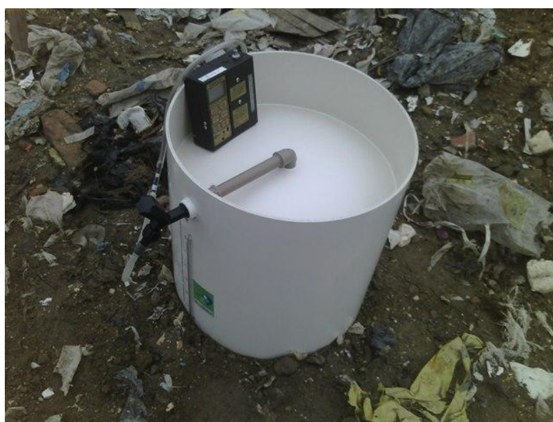
Figura 22 - Foto da câmara de fluxo utilizada nas amostragens do ACMC
