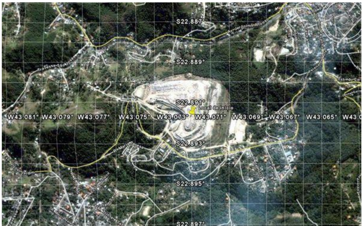
Figura 30 - Malha na região (100 m x 100 m) de estudo para levantamento topográfico.
