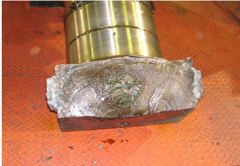
FIGURA 3.3 - Detalhe da fratura ocorrida no eixo virabrequim.
