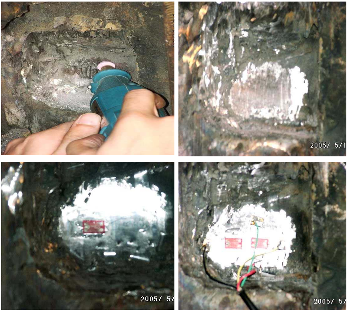
FIGURA 3.6 – Localização dos sensores para coleta de dados
