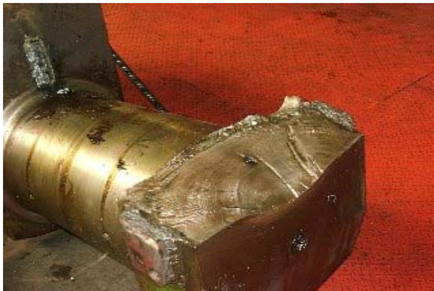
FIGURA 3.2 - Detalhe da fratura ocorrida no eixo virabrequim.
