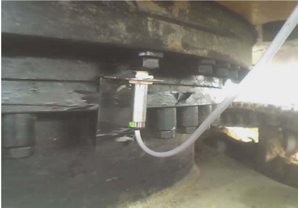
Figura 4 – Localização do sensor na base da máquina.
