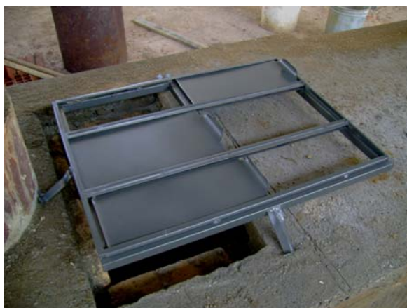
Figura 13: Vista das comportas de entrada de ar primário no combustor, antes de ser instalada sobre o combustor.
