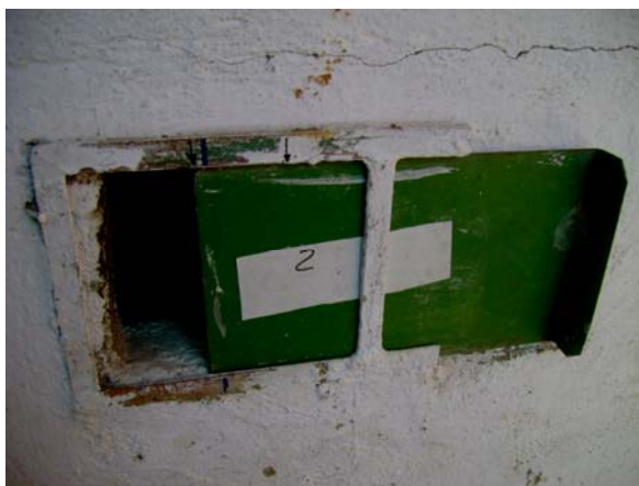
Figura 14: Entrada de ar secundário no combustor, tipo comporta.
