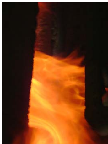
Figura 11: Visor da câmara de combustão durante um dos testes, mostrando chama vinda do reator.
