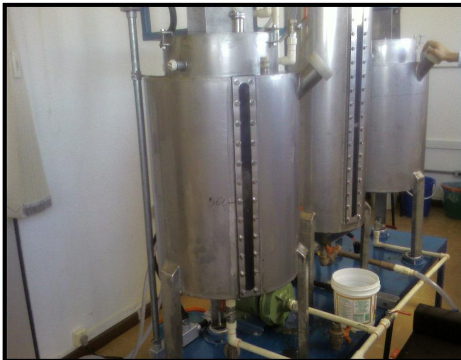
Figura 7 - Protótipo para a produção de biodiesel otimizado quanto a tubulações, bocais e visores.
