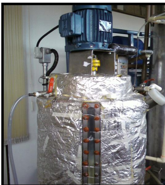
Figura 11 -Reator do protótipo com isolamento térmico.
