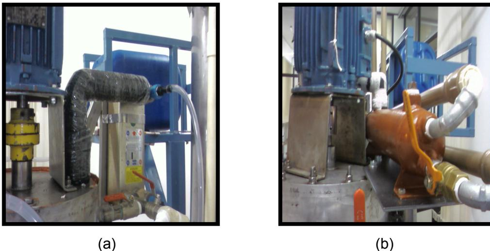
Figura 8 - Trocadores de calor utilizados nos dois reatores; (a) Trocador de Placa e (b) Trocador de casco e tubo.
