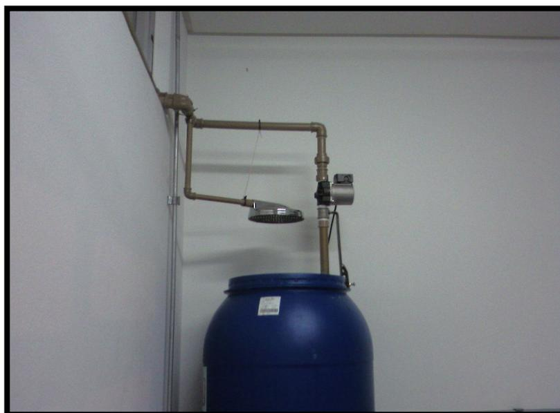
Figura 9 - Sistema de circulação da água dos trocadores de calor.
