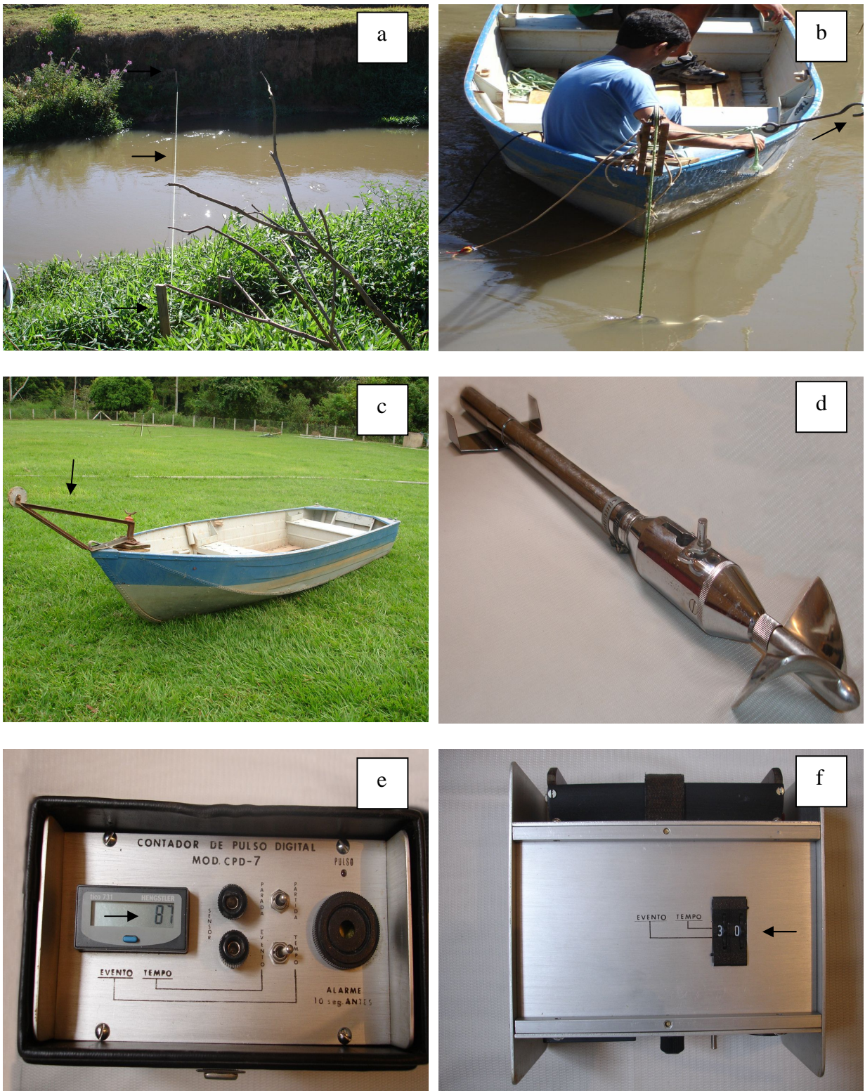
Figura 6. a- Posicionamento das estacas e da corda para posterior medição da velocidade; b - barco preso à corda por meio de um gancho; c - barco adaptado para o posicionamento do molinete; d - molinete; e - contador de giros da hélice do molinete; f - detalhe do contador de giros programado para contagem do número de voltas da hélice do molinete durante 30 segundos.
